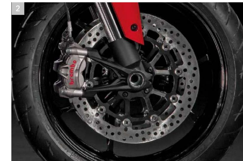
2 Freno anteriore con pinze monoblocco Brembo M50 e dischi da 330 mm
