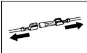
Estrarre il fusibile da sostituire
