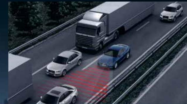
**Audi pre sense city<sup>1</sup>** – può aiutare a evitare possibili collisioni con veicoli e pedoni a velocità fino a circa 85 km/h con segnali di avvertimento e interventi frenanti
