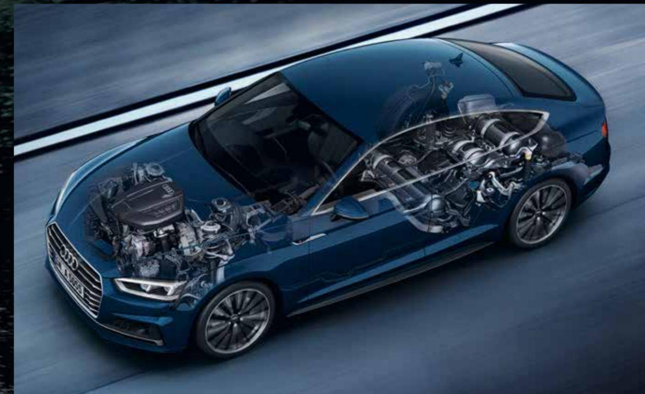
**4 serbatoi del metano leggeri e compatti** – il volume di accumulo complessivo, pari a 19 kg di metano.
