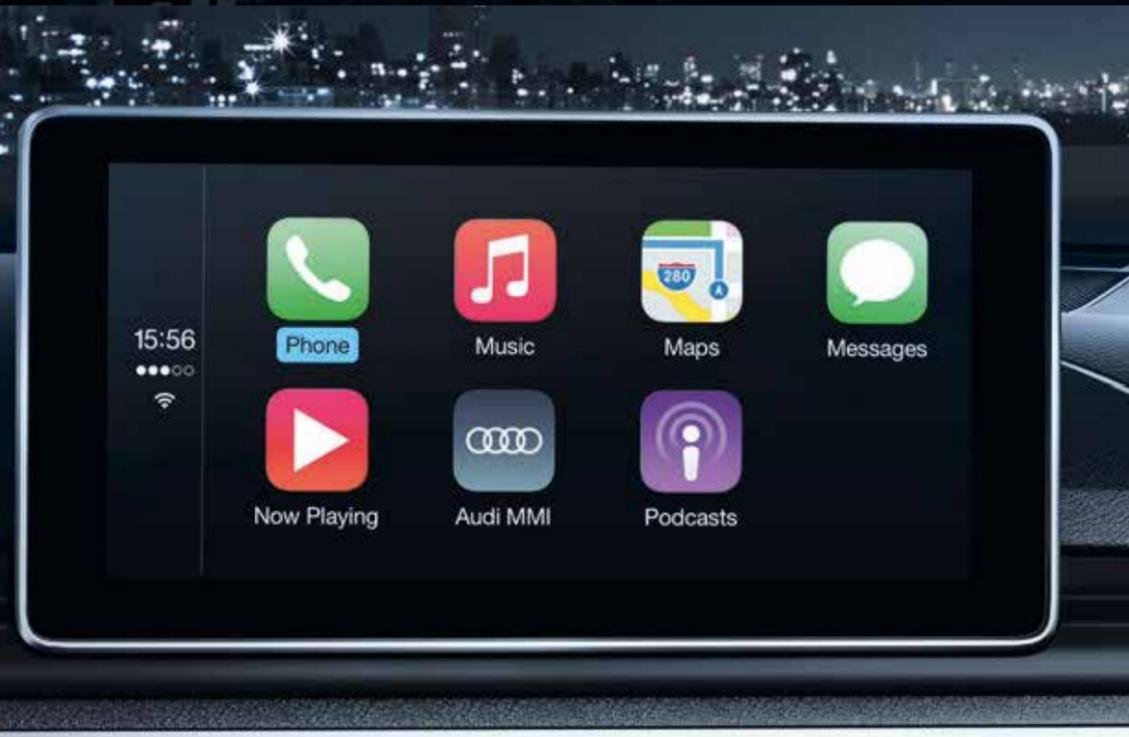
**Audi smartphone interface<sup>1, 2, 3</sup>** – collega lo smartphone alla vettura e visualizza direttamente e senza soluzione di continuità i contenuti dello smartphone sul display MMI® tramite USB
