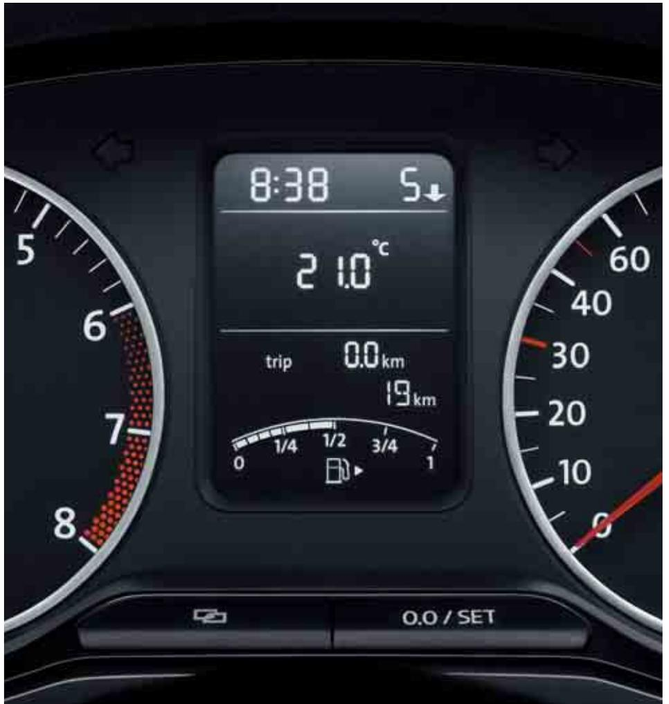
Il **display multifunzionale** ti fornisce, durante il percorso, utili informazioni come il consumo medio, la velocità media, l'autonomia di carburante, l'ora e la temperatura esterna. Per tutti i modelli con motore diesel è compresa, inoltre, l'indicazione di marcia consigliata (di serie per BiFuel).
