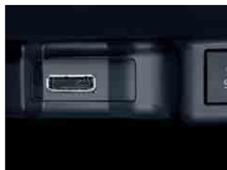
La predisposizione **Multimedia MEDIA-IN** con interfaccia USB consente il collegamento di fonti audio esterne ed il loro comando tramite l'autoradio o il sistema di radio-navigazione.
