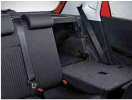
I sedili posteriori a divisione asimmetrica con lo schienale ribaltabile creano lo spazio necessario per il trasporto di oggetti ingombranti. Con il divano posteriore ribaltato in avanti otterrai una superficie di carico quasi piana.
