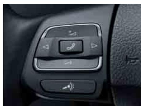
La predisposizione per il telefono cellulare dispone di sistema vivavoce, funzione "mute" ed interfaccia Bluetooth (adattatore telefono necessario per la connessione al vivavoce disponibile nella linea Accessori Originali Volkswagen®).
