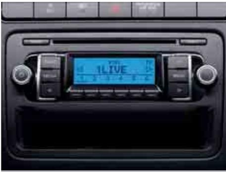
L'autoradio "RCD 210" con funzione di riproduzione MP3, compresa l'indicazione dei titoli e sintonizzatore CD, 2 x 20 Watt di potenza in uscita, quattro altoparlanti anteriori, selezione del titolo, selezione casuale del titolo e sistema automatico di riproduzione del titolo.
