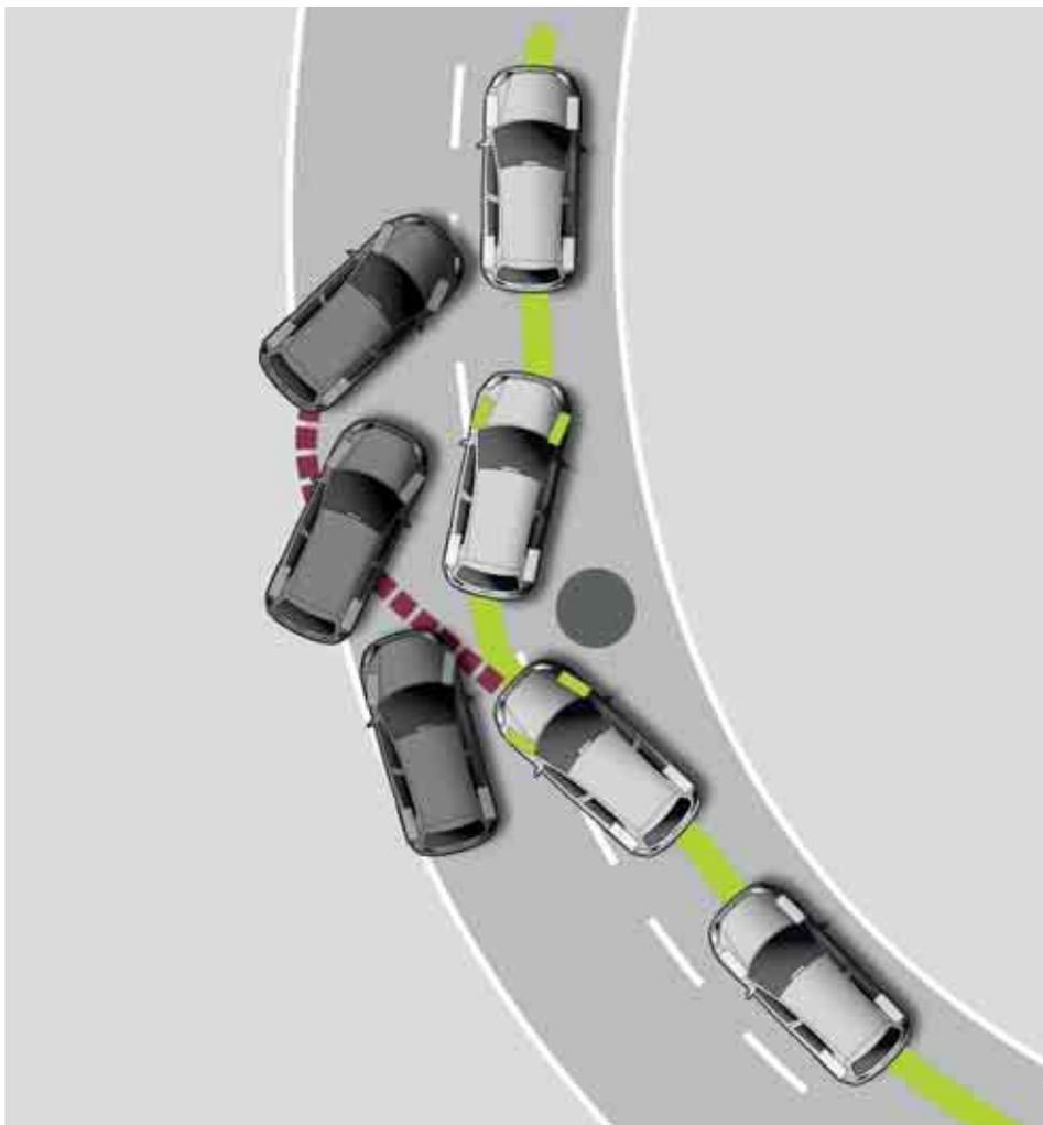
Il **programma elettronico di controllo della stabilità (ESP)** con sistema di assistenza per partenze in salita Hill Hold, impedisce lo sbandamento della vettura, intervenendo in modo mirato sulla gestione del sistema frenante e del motore conferendo alla vettura la massima stabilità direzionale.
