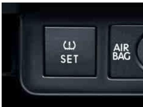
Il sensore di pressione pneumatici ti tiene aggiornato sulla pressione dei pneumatici, un fattore di sicurezza sottoposto automaticamente ad intervalli regolari a costante verifica (di serie per BiFuel).
