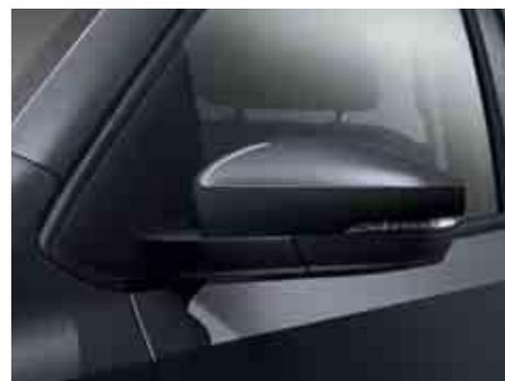
Lo specchietto retrovisore esterno con indicatore direzionale integrato è verniciato nel colore della carrozzeria (di serie). Gli specchietti retrovisori esterni, a partire dall'allestimento Comfortline, sono regolabili elettricamente e riscaldabili.
