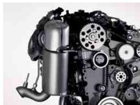
Il **filtro diesel antiparticolato** consente la filtrazione delle particelle di fuliggine dei gas di scarico del motore maggiormente inquinanti e nocive per la salute ed aiuta in questo modo a ridurre in modo significativo le emissioni di polveri sottili.
