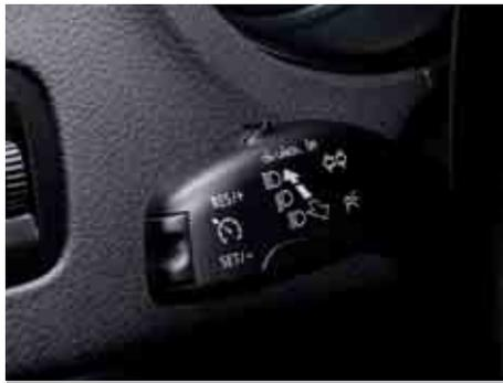
A partire da 30 km/h il **regolatore di velocità** mantiene la velocità da te selezionata senza dover premere l'acceleratore. Si disattiva automaticamente se viene azionato il freno oppure la frizione.
