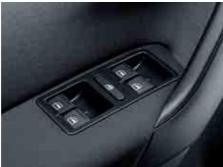
Gli alzacristalli elettrici anteriori e posteriori (di serie per 5 porte) permettono una migliore regolazione del flusso d'aria. Molto importante per la tua sicurezza: non appena il sistema molto sensibile di protezione antischiacciamento avverte una minima resistenza tra il finestrino ed il telaio, il vetro viene subito abbassato leggermente.
