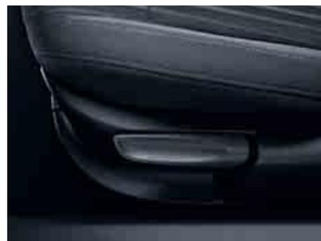
I sedili anteriori regolabili in altezza ti aiutano a mantenere una posizione di seduta molto confortevole.
