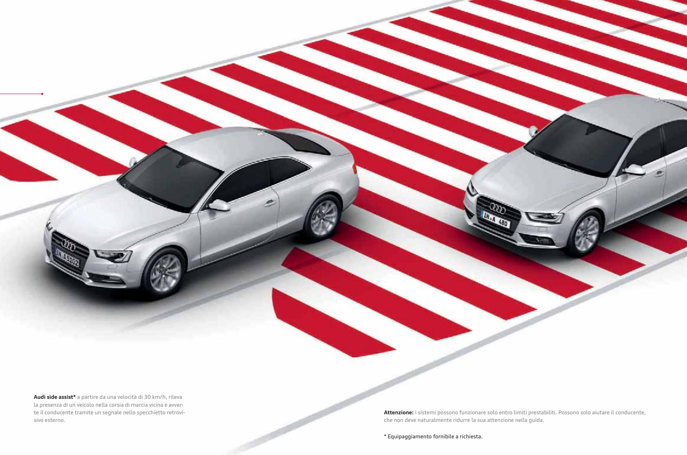
**Audi side assist\*** a partire da una velocità di 30 km/h, rileva la presenza di un veicolo nella corsia di marcia vicina e avverte il conducente tramite un segnale nello specchietto retrovisivo esterno.
