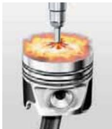
**Gli iniettori piezoelettrici** si aprono e si chiudono in frazioni di millesimi di secondo, iniettando più volte il carburante nella camera di combustione ad una pressione fino a 2.000 bar. Ad ogni fase vengono iniettate minuscole quantità di carburante, inferiori a un millesimo di grammo.
