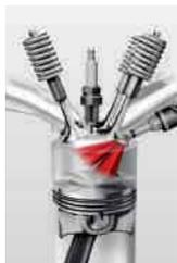
La centralina motore calcola la quantità d'iniezione e il punto d'innesco del carburante in funzione della potenza richiesta dal conducente. In modalità normale la pressione d'iniezione è compresa tra 30 e 120 bar.
