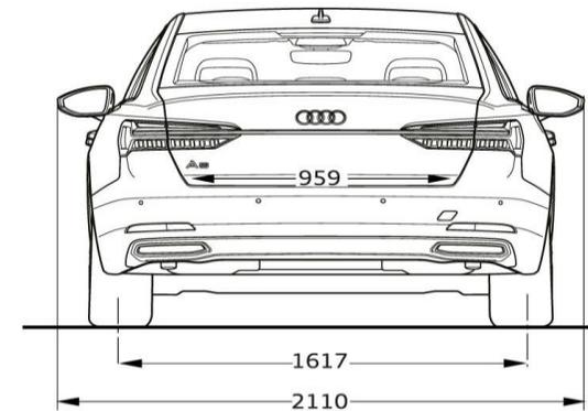
**Misure in millimetri** (indicazione delle dimensioni con massa a vuoto)
