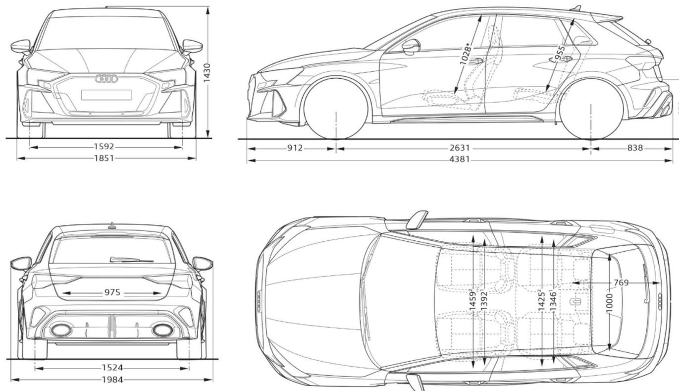
**NOTE:****Misure in millimetri** (indicazione delle dimensioni con massa a vuoto)
