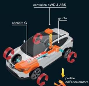
**ALL MODE 4X4-I<sup>®</sup>:** su strada o fuori strada il computer e i sensori del sistema 4x4-i<sup>®</sup> ottimizzano la trazione. Il sistema rileva eventuali slittamenti delle ruote e ripartisce in automatico la coppia tra asse anteriore e asse posteriore fino ad un massimo di 50/50.
