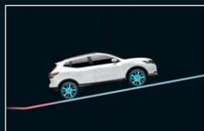
**SISTEMA DI ASSISTENZA IN SALITA.** Nel momento in cui schiacci la frizione e acceleri in salita, il sistema blocca la vettura per 2 secondi e ne evita l'arretramento.
