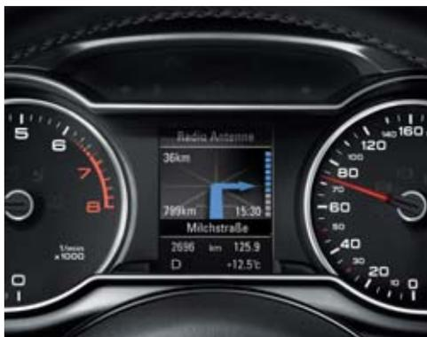
**Sistema d'informazioni per il conducente con display a colori**
