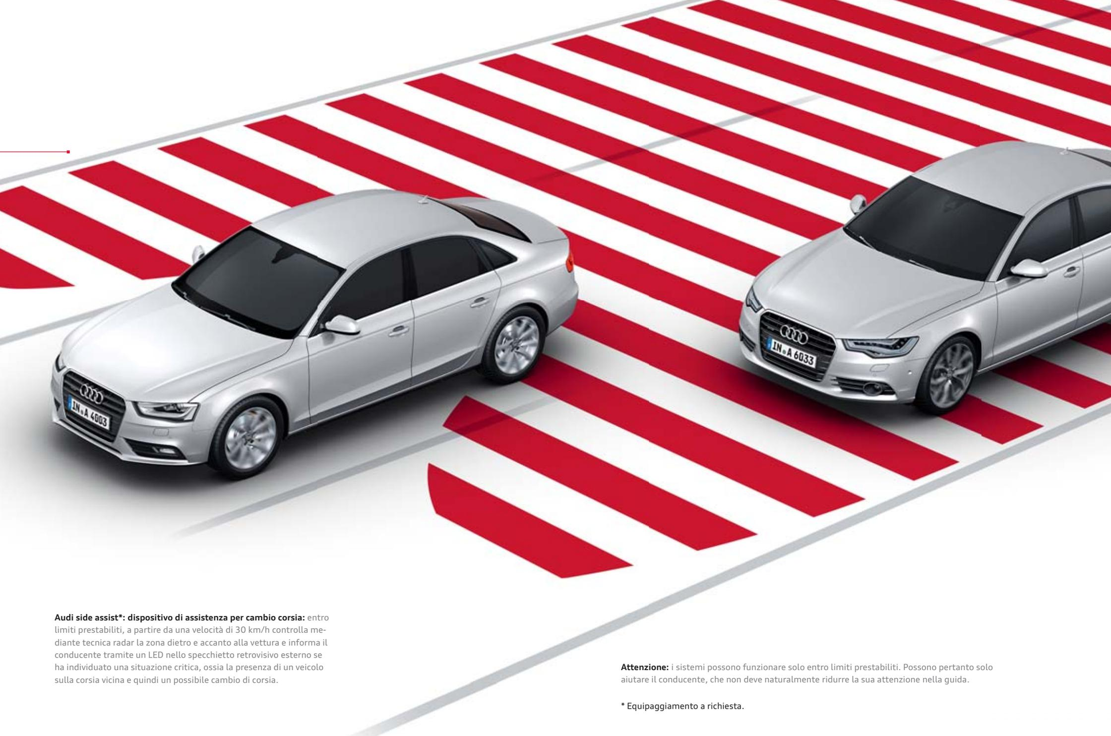
**Audi side assist\*:** dispositivo di assistenza per cambio corsia: entro limiti prestabiliti, a partire da una velocità di 30 km/h controlla mediante tecnica radar la zona dietro e accanto alla vettura e informa il conducente tramite un LED nello specchietto retrovisivo esterno se ha individuato una situazione critica, ossia la presenza di un veicolo sulla corsia vicina e quindi un possibile cambio di corsia.
