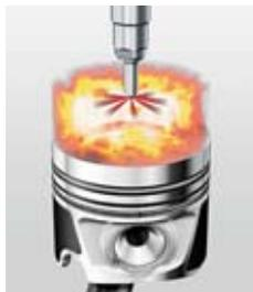
**La preiniezione** consente una combustione «morbida» e quindi un minore rumorosità e un funzionamento più dolce del motore.
