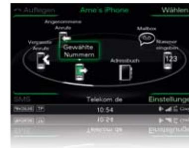
**Telefono cellulare/Bluetooth:** la predisposizione cellulare (Bluetooth) e il Bluetooth con sistema veicolare Audi sono dotati di uno schermo di selezione contenente elenchi di chiamate, rubrica e pulsante di selezione.
