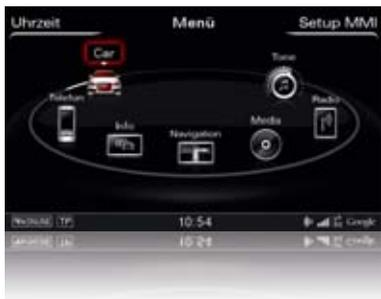
**Car:** questa funzione consente di controllare direttamente i sistemi di assistenza alla guida, regolazioni della vettura, climatizzatore e service.
