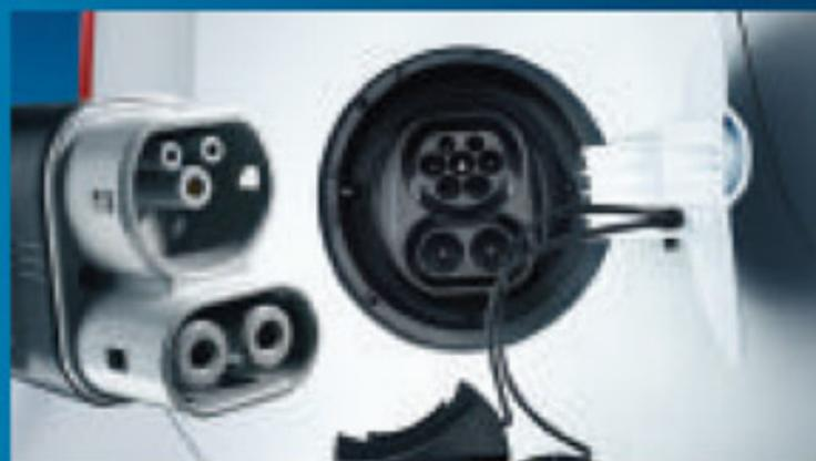
Grazie al Combined Charging System, nuova e-up! ha una presa di corrente con due spine diverse. La prima è la ricarica standard a corrente alternata che funziona con presa di rete domestica, con le colonnine di ricarica pubbliche e con la Wallbox. La seconda spina, per la ricarica rapida, funziona con le colonnine a corrente continua. Quest'ultima richiede solo 30 minuti per caricare una batteria all'80%.
