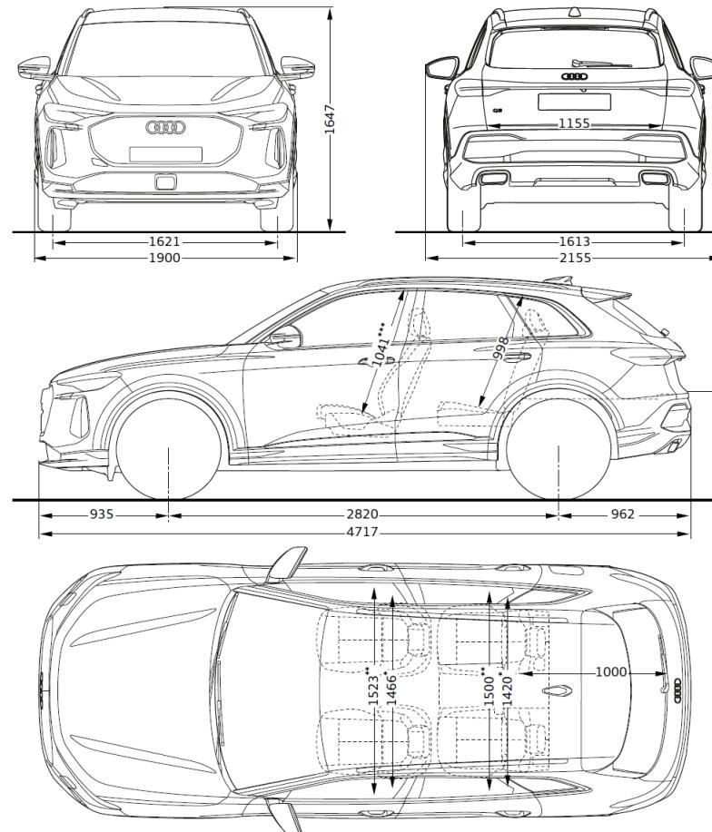
**Misure in millimetri** (indicazione delle dimensioni con massa a vuoto)
