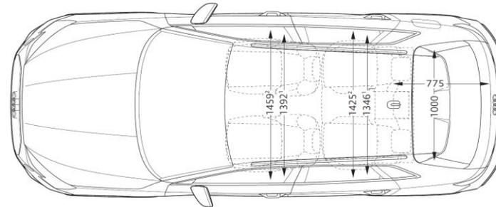
**NOTE:****Misure in millimetri** (indicazione delle dimensioni con massa a vuoto)
