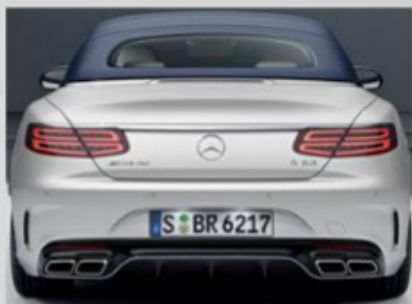
Impianto di scarico con quattro doppi terminali
