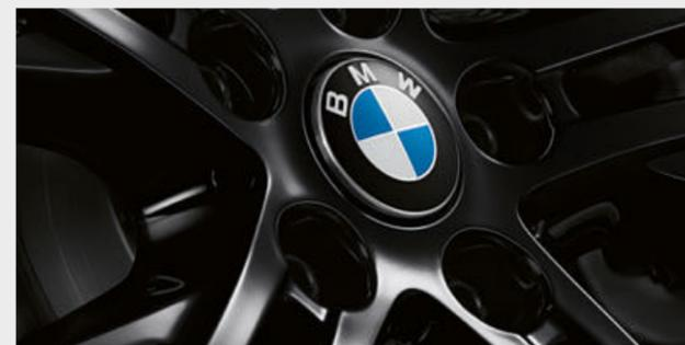
○ Il coprimozzo fisso è dotato di logo BMW che non gira più insieme alla ruota, ma rimane fermo in orizzontale. Il coprimozzo può essere installato su tutte le ruote BMW in lega leggera con un diametro foro pari a 112 mm.
