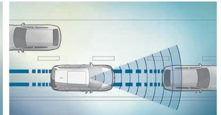
■ L'**avvisatore di possibile tamponamento con funzione city brake<sup>2</sup>** aiuta attivamente il guidatore ad evitare tamponamenti o a ridurne la gravità, avvisandolo per tempo fino a una velocità di 60 km/h. Al tempo stesso predispose i freni a una risposta più rapida e con l'optional Driving Assistant frena automaticamente nei casi d'emergenza.
