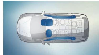
■ Gli **airbag per guidatore e passeggero** fanno parte del sistema di sicurezza BMW nel quale tutti i componenti sono armonizzati con precisione. Sei airbag offrono ai passeggeri una protezione ottimale: airbag anteriori, airbag per la testa per tutta la superficie dei cristalli laterali e airbag laterali integrati negli schienali dei sedili anteriori.
