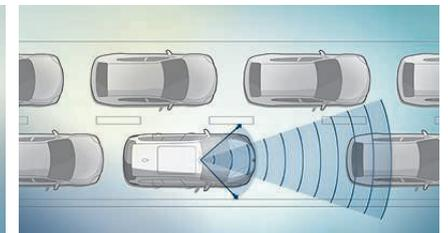
□ Sulle autostrade con traffico molto intenso, fino a 60 km/h il **Traffic Jam Assistant<sup>1</sup>** regola automaticamente la velocità, la distanza e perfino la sterzata mantenendo il veicolo nella propria corsia di marcia.
