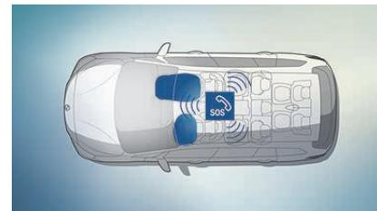
□ In caso di necessità la **chiamata d'emergenza intelligente** vi mette automaticamente in collegamento con il centro soccorsi più vicino mediante il BMW Call Center, in modo indipendente dal vostro cellulare. Oltre alla posizione esatta del veicolo vengono trasmessi anche dati sulla gravità dell'incidente. La chiamata d'emergenza intelligente può essere attivata anche manualmente e per soccorrere altre vetture.
