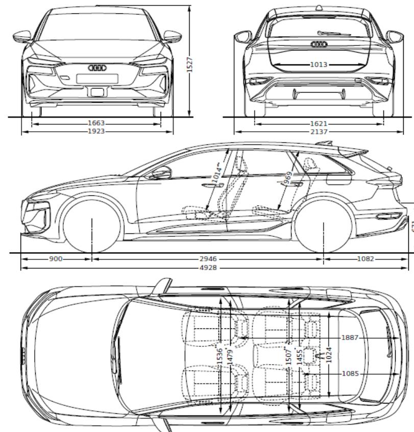
**Misure in millimetri** (indicazione delle dimensioni con massa a vuoto)
