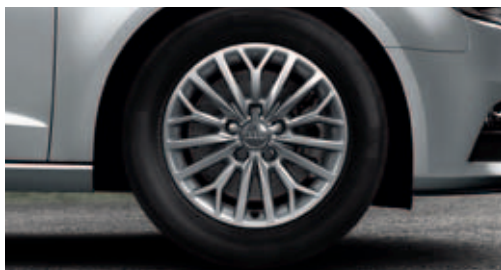
Cerchi in lega di alluminio con design a 15 razze a Y trapezoidali 7 J x 16 con pneumatici 205/55 R 16 (di serie per Ambiente)
