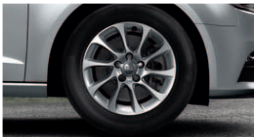
Cerchi in lega di alluminio a 10 razze 6,5 J x 16 con pneumatici 205/55 R 16 (di serie per Attraction)
