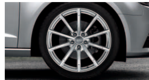
Cerchi in lega di alluminio Audi exclusive a 10 razze* 7,5 J x 18 con pneumatici 225/40 R 18 Una proposta quattro GmbH
