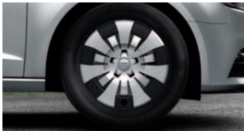
Cerchi in acciaio con copri ruota integrati 6,5 J x 16 con pneumatici 205/55 R 16 (di serie per A3 Young)
