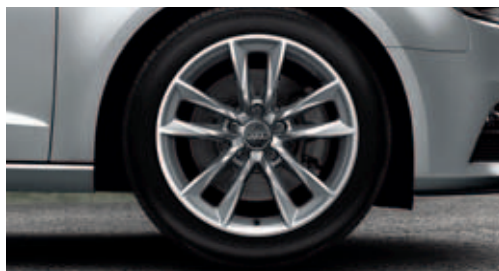
Cerchi in lega di alluminio a 5 razze design cinetico 7,5 J x 17 con pneumatici 225/45 R 17
