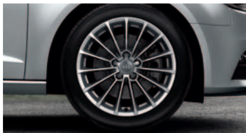
Cerchi in lega di alluminio a 15 razze 7,5 J x 17 con pneumatici 225/45 R 17
