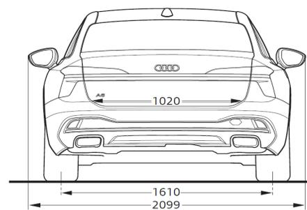
**Misure in millimetri** (indicazione delle dimensioni con massa a vuoto)
