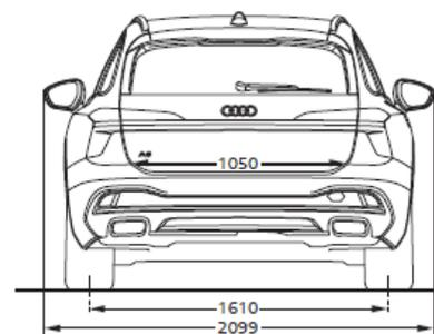
**Misure in millimetri** (indicazione delle dimensioni con massa a vuoto)
