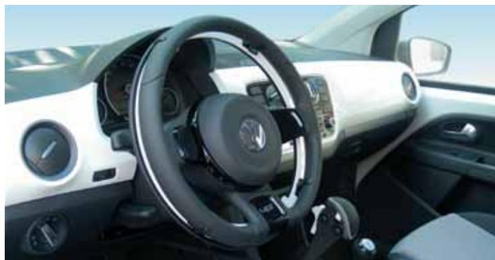
Acceleratore elettronico rotativo sotto il volante "Ghost" e freno di servizio a leva verticale.
