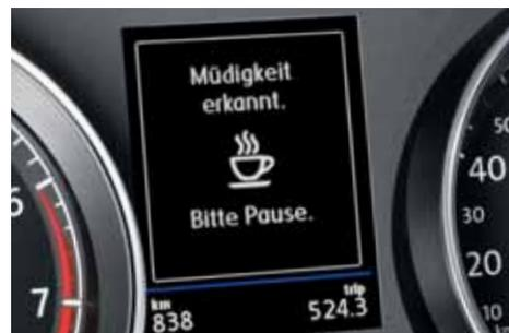
Il sistema di rilevazione della stanchezza Fatigue Detection, di serie su tutta la gamma, controlla il comportamento del conducente attraverso il monitoraggio dei movimenti dello sterzo. Se il sistema registra i segnali di un possibile colpo di sonno imminente, consiglia al conducente di fare una pausa attraverso appositi segnali acustici e visivi.
