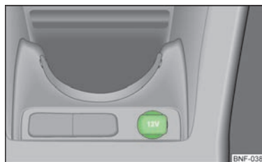
Fig. 46 Consolle centrale: Presa di corrente
