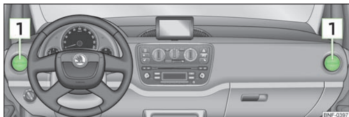
Fig. 57 Bocchette di ventilazione
