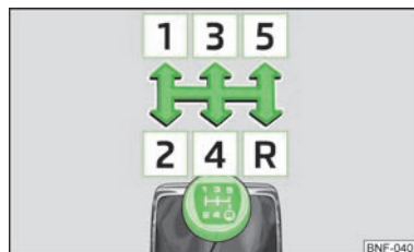
Fig. 63 Schema marce del cambio meccanico a 5 rapporti
