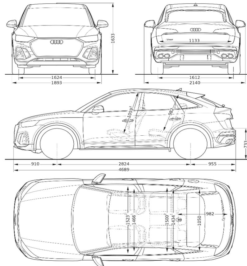
**Misure in millimetri.**
