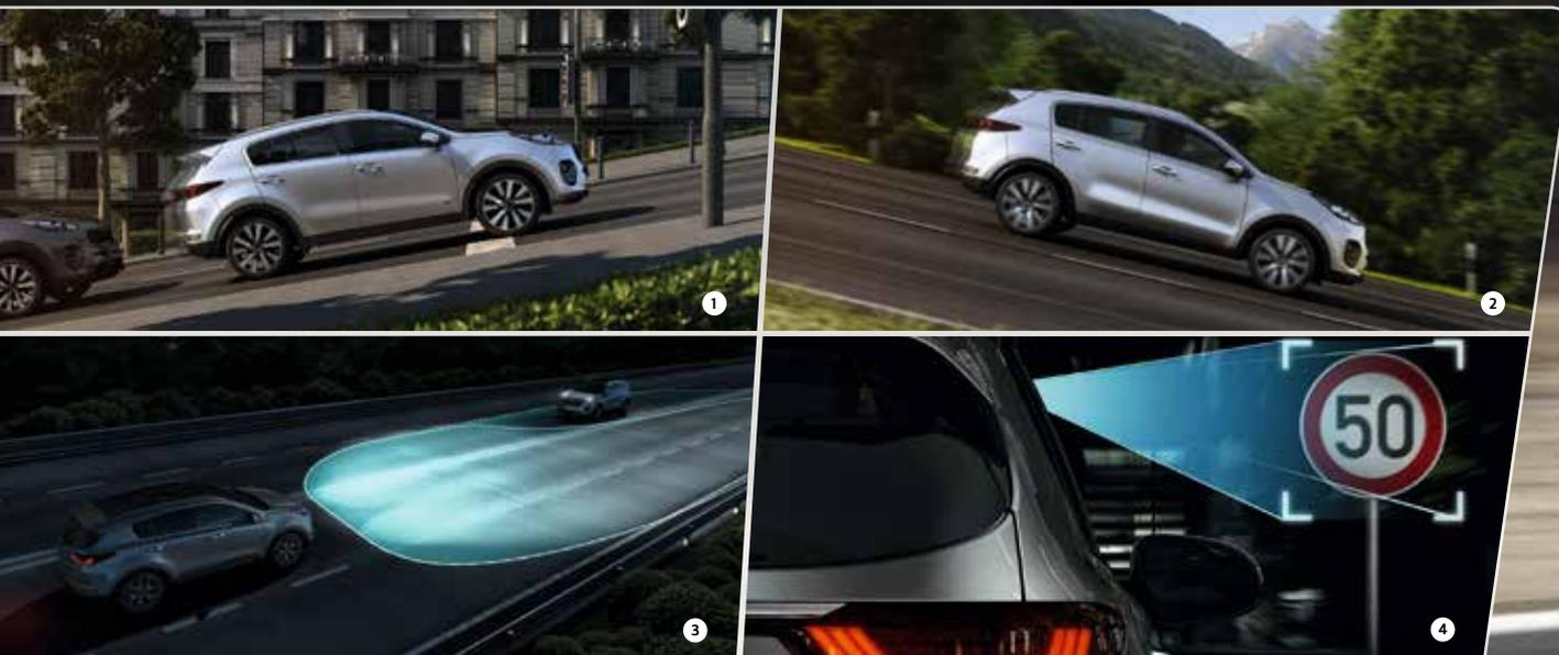
1. Il sistema **Hill Start Assist Control** impedisce al veicolo di arretrare durante le partenze in salita.
