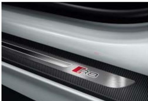
**Listelli sottoporta in carbonio opaco o carbonio lucido con inserti in alluminio illuminati Audi exclusive** con logo R8 alle longarine sottoporta. Illuminazione della cornice interna degli inserti in alluminio e del logo R8
