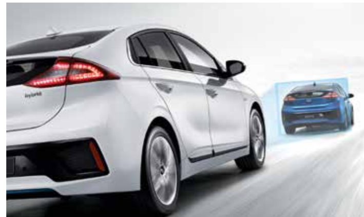
Autonomous Emergency Braking (AEB) Se viene rilevato un pericolo di impatto con un veicolo o un pedone, l'AEB emette un immediato segnale visivo e acustico, quindi interviene applicando una frenata automatica, parziale o totale.
