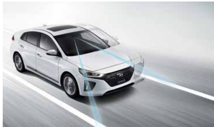
Lane Keeping Assist System (LKAS) Avvisa il guidatore in caso di involontari spostamenti dalla linea della carreggiata e, se necessario, applica correzioni allo sterzo.
