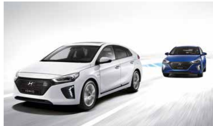
Blind Spot Detection (BSD) Sensori montati sulle fiancate posteriori dell'auto rilevano la presenza di un veicolo oscurato dall'angolo cieco e avvisano con un segnale acustico nel caso venga attivato un indicatore di direzione.
