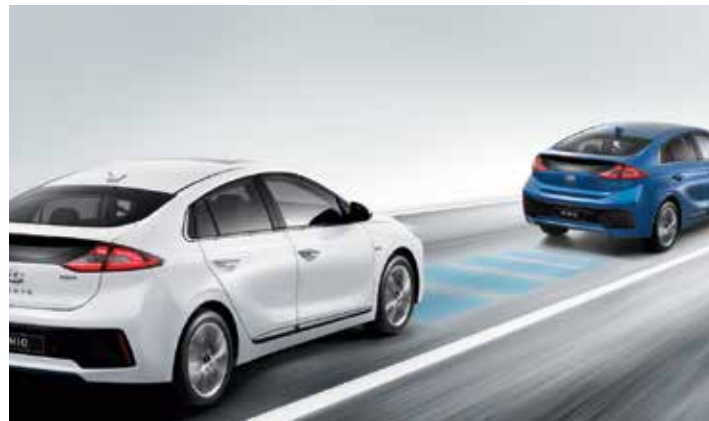
Smart Cruise Control (SCC) Aumenta la sicurezza e riduce lo stress mantenendo una distanza fissa dal veicolo che precede, riducendo o aumentando automaticamente la velocità fino al limite prefissato, in base alle condizioni del traffico.
