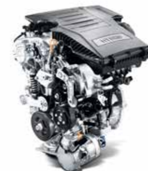
Massima efficienza: il 1.6 GDI a benzina, progettato appositamente per IONIQ, raggiunge il 40% di efficienza termica, al vertice della categoria (Ibride e Plug-in).
