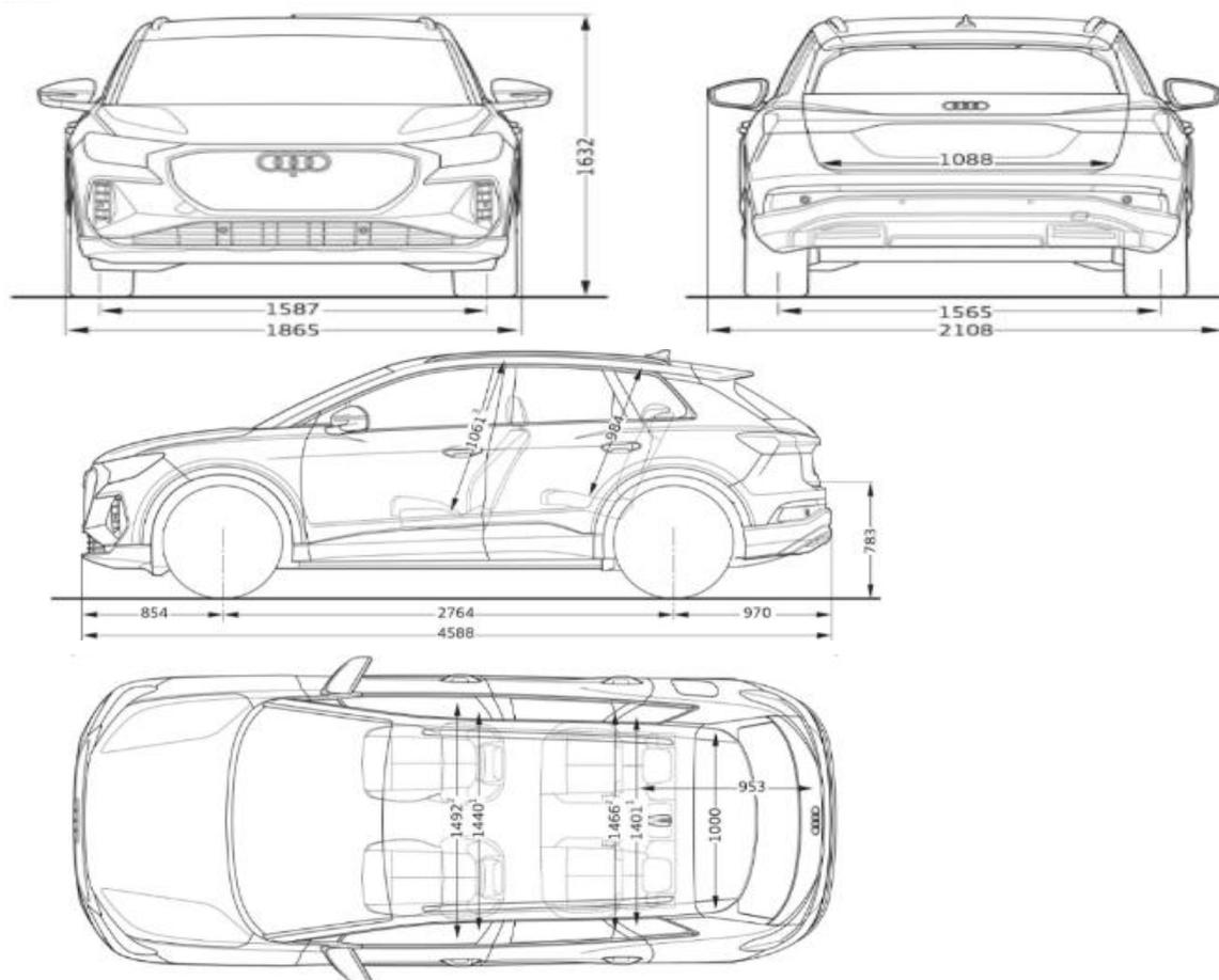
**Misure in millimetri** (indicazione delle dimensioni con massa a vuoto)
