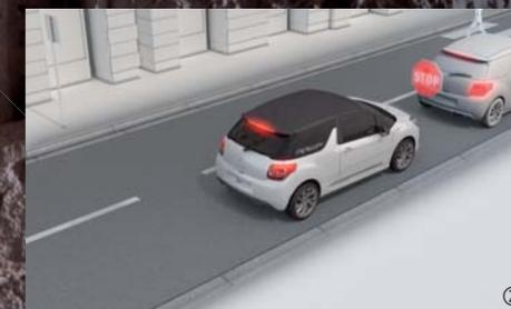
② Quando il veicolo si muove a meno di 30 km/h, il sensore aziona la frenata automatica al fine di evitare la collisione.
