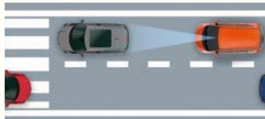
**1:** Nella guida in città, a velocità comprese tra i 5 - 32 km/h, il sistema monitora la distanza dalla macchina che precede per aiutarti ad evitare una collisione.
