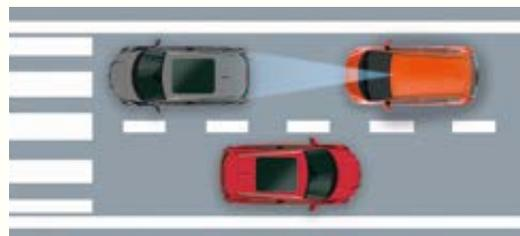
**2:** Se la distanza dal veicolo rilevato continua a diminuire il sistema fornisce un avviso acustico e visivo sul display i-MID.
