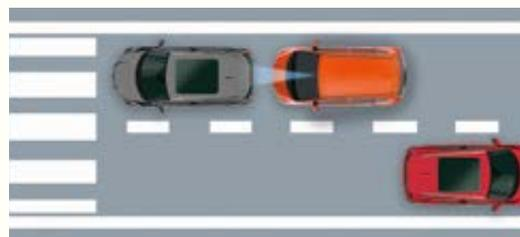
**3:** Se il guidatore non reagisce e la collisione diventa imminente, il City-Brake Active System applicherà automaticamente la frenata d'emergenza per ridurre il più possibile la velocità: in buone condizioni di guida il sistema consente perfino di evitare l'incidente.
