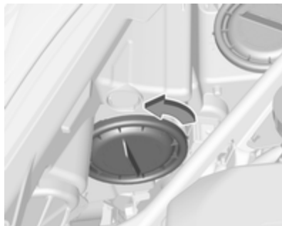
Anabbaglianti (1) lampadina esterna. Abbaglianti (2) lampadina interna.
