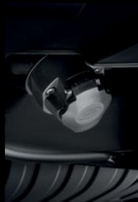
**Cablaggio elettrico a 13 pin†**
