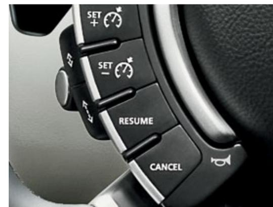
Il sistema di controllo della velocità di crociera adattivo (ACC) può essere impostato con quattro regolazioni di innesco variabile tra 1,0 e 2,2 secondi dalla vettura davanti in condizioni di guida normali, oppure quando viene selezionato uno dei programmi Erba/Ghiaia/Neve del Terrain Response®.
