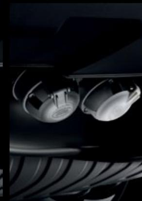
**Cablaggi elettrici tipo 'N' e 'S' a 12 pin†**
