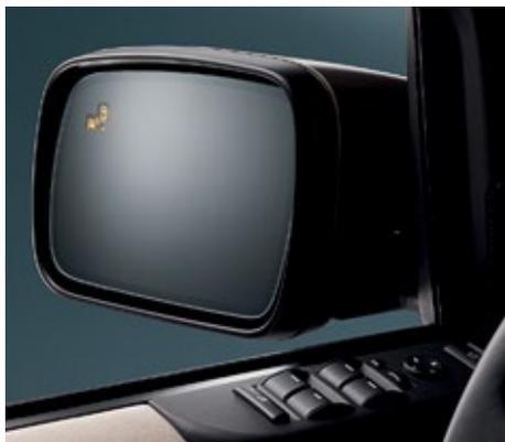
Il Blind Spot Monitor utilizza un radar per rilevare l'avvicinarsi di veicoli nell'angolo cieco del guidatore. Una spia color ambra si illumina nel relativo specchietto retrovisore esterno quando viene identificato un pericolo.
