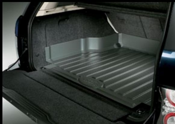
**Protezione rigida per vano carico**
