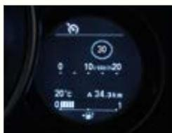
Il sistema utilizza la telecamera per rilevare la segnaletica stradale fino a 100 mt di distanza, visualizzandola nel display i-MID. Possono essere visualizzati due segnali stradali contemporaneamente.
