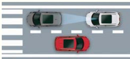
**2:** Se la distanza continua a diminuire il sistema fornisce un avviso acustico e visivo sul display i-MID.
