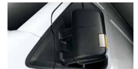
Specchietti retrovisori esterni con indicatori di direzione integrati
