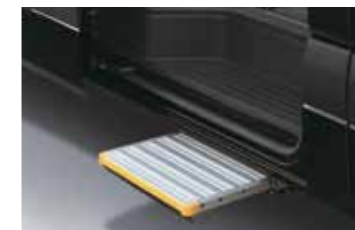
Scalino elettrico passeggero
