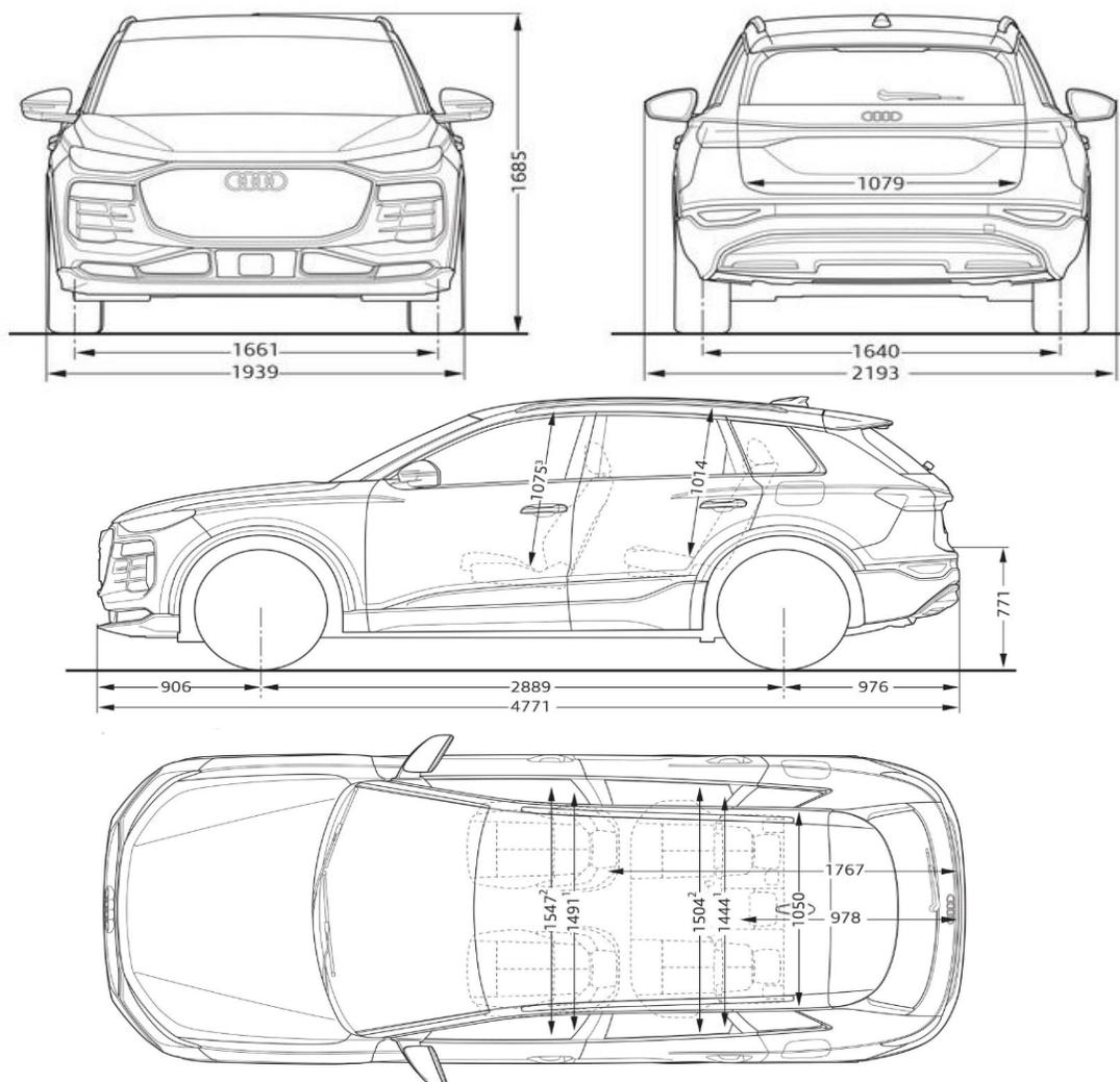
**Misure in millimetri** (indicazione delle dimensioni con massa a vuoto)
