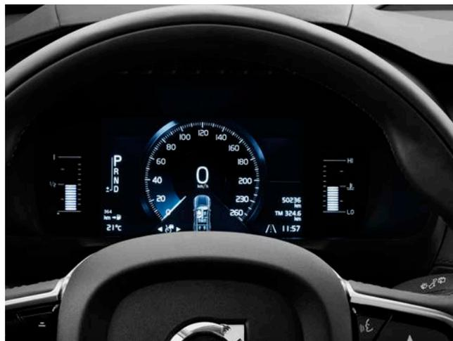
Il quadro strumenti digitale da 8" permette di scegliere tra diverse modalità grafiche. Per fornire un'ottima visibilità, la lucentezza del display si adatta automaticamente alle condizioni di luce esterna.
