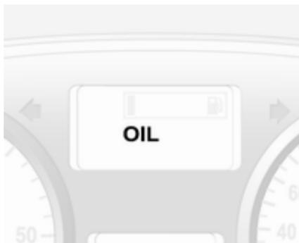
Se viene raggiunto il livello minimo di olio motore, il messaggio **OIL** verrà visualizzato nel Driver Information Centre per 30 secondi dopo lo spegnimento del quadro. Controllare il livello dell'olio ↻ 118.
