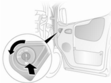
Gli airbag del passeggero anteriore sono disattivati tramite un interruttore sulla portiera del passeggero anteriore.
