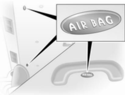
Il sistema airbag a tendina è composto da due airbag incorporati nel telaio del tetto, uno per lato. La loro presenza viene segnalata dalla scritta **AIRBAG** sul padiglione del tetto.
