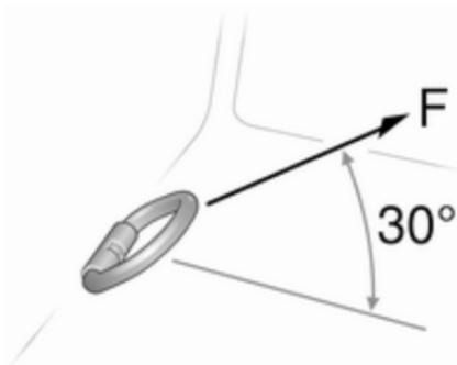
Gli occhielli di ancoraggio servono per fissare oggetti, per es. con cinghie di ancoraggio o una rete di contenimento, per impedire che questi scivolino.
