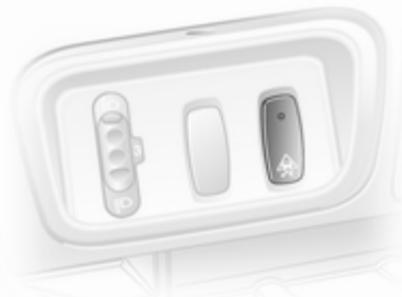
Quando si richiede lo slittamento delle ruote motrici, il controllo della trazione può essere disattivato.
