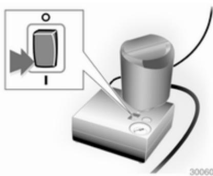
9. Portare l'interruttore basculante sul compressore in posizione **I**. Il pneumatico viene riempito di sigillante.
