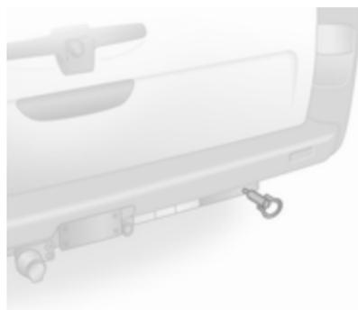
I veicoli con dispositivo di traino sono dotati di opportuna predisposizione per l'occhiello di traino rimovibile. Evitare l'occhiello di traino completamente nella predisposizione usando gli attrezzi in dotazione al veicolo.
