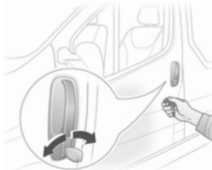
Ruotare la chiave nella serratura della portiera del conducente. Aprire le portiere tirando la rispettiva maniglia.
