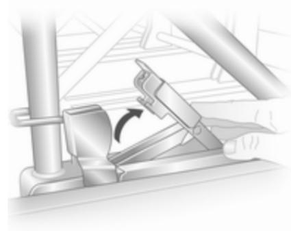
Con entrambi i fermi sollevati, spingere tutto il sedile all'indietro sgan-ciandolo dai punti di ancoraggio del pavimento. Ora il sedile può essere rimosso.
