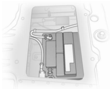
Smontare la piastra di copertura per accedere alla batteria.
