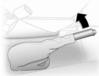
Applicare sempre il freno di stazionamento con fermezza senza premere il pulsante di sblocco, e applicarlo con la maggior forza possibile in salita o in discesa.
