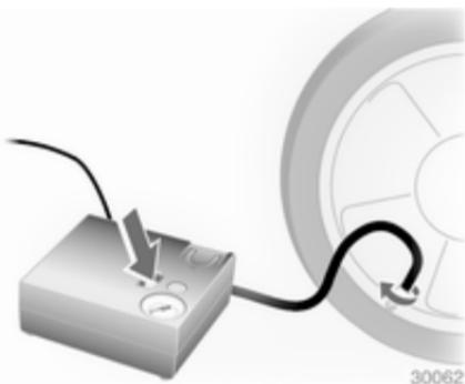
16. Mettersi immediatamente in marcia, in modo da distribuire uniformemente il sigillante nel pneumatico. Dopo aver percorso circa 10 km, non oltre 10 minuti di viaggio), fermarsi e controllare la pressione dei pneumatici con il compressore. Nel fare questo, avvitare direttamente il tubo dell'aria del compressore sulla valvola del pneumatico.
