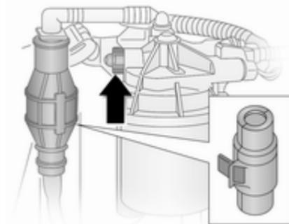
Se il serbatoio del carburante si è svuotato, è necessario spurgare l'impianto di alimentazione del diesel.
