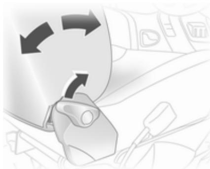
Tirare la leva, regolare l'inclinazione e rilasciare la leva. Il sedile deve scattare in posizione. Non appoggiarsi allo schienale durante la regolazione.
