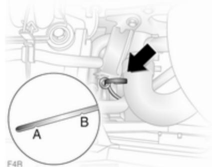
Le astine di livello variano a seconda del tipo di motore. Le figure mostrano come controllare il livello dell'olio motore e come effettuare il rifornimento rispettivamente nei motori a benzina e diesel.
