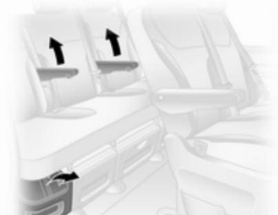
Durante il ribaltamento o lo smontaggio del sedile posteriore, verificare che i braccioli siano ripiegati completamente verso l'alto.
