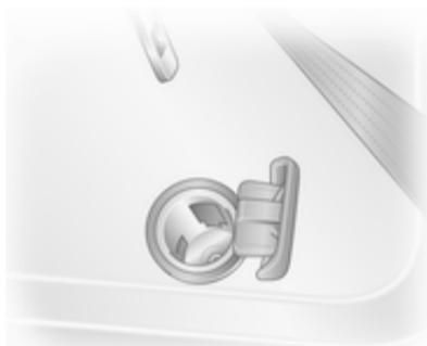
Il collegamento di accessori elettrici a motore spento può scaricare la batteria. Non superare il consumo massimo di 120 watt. Non collegare accessori che generano corrente, come caricabatterie o batterie.
