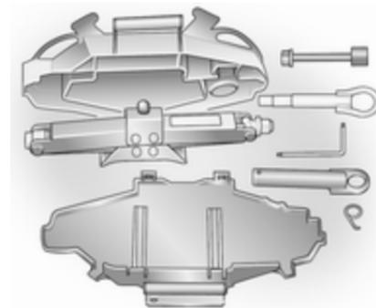
Martinetto, adattatori, cricchetto, chiave Torx, gancio per coprimozzo, occhiello di traino e attrezzi per la ruota di scorta sono riposti in un contenitore sotto il sedile del conducente.
