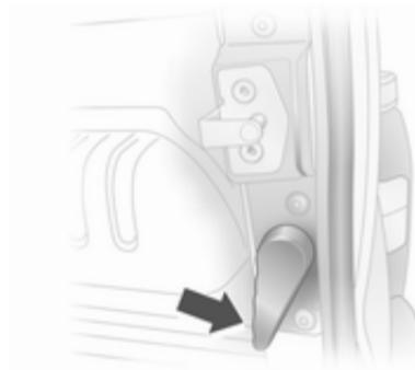
Per aprire la porta posteriore destra è necessario sbloccarla tramite la leva.
