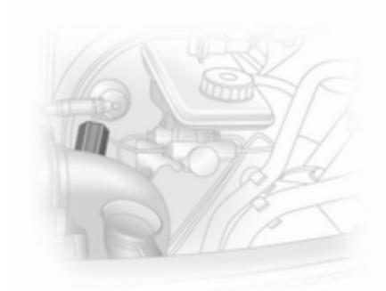
Alcuni modelli dispongono di un indicatore nel sistema di induzione del motore che indica una strozzatura dell'aspirazione dell'aria al motore.
