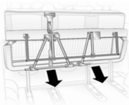
Per riportare il sedile in posizione originale, sostenere tutto il sedile e sganciare la barra tirandola verso se stessi.
