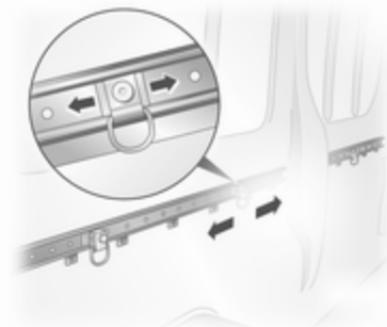
Le barre di ancoraggio presenti nel vano di carico forniscono punti regolabili per l'ancoraggio del carico.
