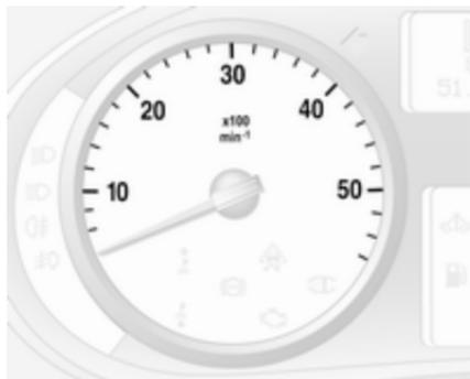
Indica la velocità di rotazione del motore.
