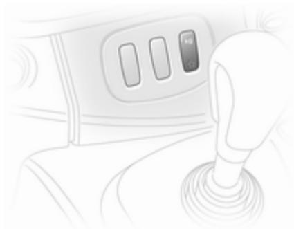
La modalità Laden può essere utilizzata sia in modalità manuale che in quella automatica. In entrambi i casi, la configurazione di innesto delle marce verrà automaticamente regolata per adattarsi all'aumento di carico utile.
