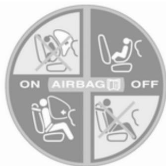
Il dispositivo di disattivazione degli airbag è segnalato da un'etichetta sul lato del cruscotto, visibile con la portiera del passeggero anteriore aperta.
