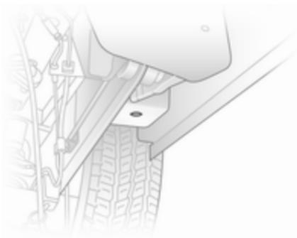
3. Sollevare il veicolo posizionando la chiave di guida della piastra di sollevamento del martinetto sotto il foro di sollevamento più vicino alla ruota da sostituire.
