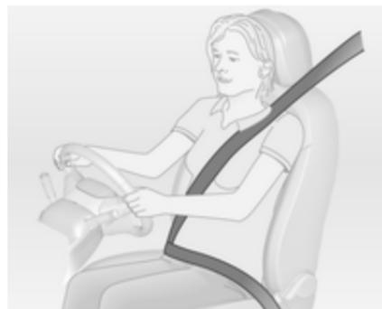
Le cinture di sicurezza si bloccano in caso di accelerazioni o decelerazioni repentine, mantenendo gli occupanti del veicolo in posizione seduta. In questo modo il rischio di lesioni si riduce notevolmente.
