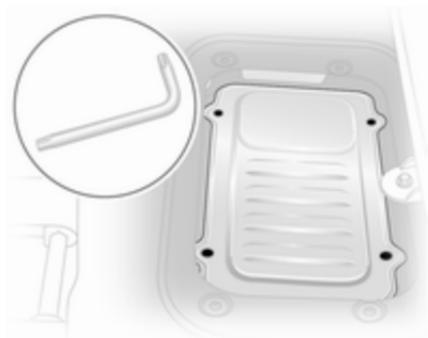
La batteria si trova sotto il pannello del pavimento del sedile anteriore sinistro. Sollevare la copertura del pavimento e utilizzare l'attrezzo incluso nel kit attrezzi (o nel kit di riparazione dei pneumatici) per allentare le 4 viti.
