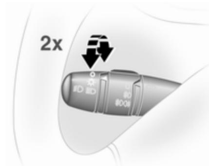
Quando la funzione di controllo automatico dei fari è attivata e il motore è acceso, il sistema alterna le luci di marcia diurna ed i fari a seconda delle condizioni di luminosità.
