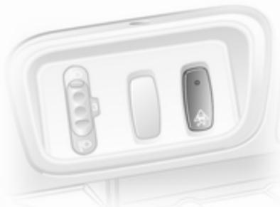
Quando si richiede lo slittamento delle ruote motrici, il sistema ESP®Plus può essere disattivato.
