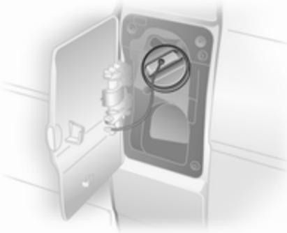
Per sbloccare e rimuovere il tappo, inserire la chiave e ruotarla in senso antiorario. Al termine del rifornimento,
