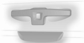
Dopo aver effettuato lo sbloccaggio delle portiere con il telecomando, premere il pulsante del portellone e aprire completamente il portellone.
