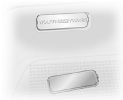
Il numero di telaio (VIN) è inoltre riportato sotto un coperchio rimovibile di plastica sul gradino della portiera destra.
