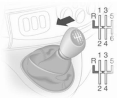
Retromarcia: con il veicolo fermo, attendere 3 secondi premendo il pedale della frizione, quindi sollevare il collare sulla leva del cambio e innestare la marcia.
