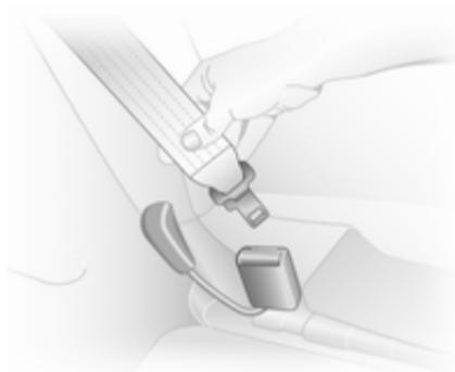
Prima di indossare la cintura, inserire la linguetta inferiore nella fibbia sulla parte esterna del sedile.
