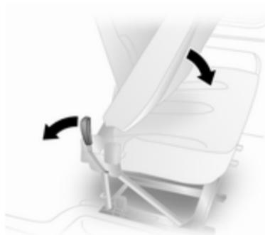
Per agevolare l'accesso ai sedili posteriori, ripiegare lo schienale in avanti. Se necessario, sganciare la cintura a doppio attacco dalle fibbie.
