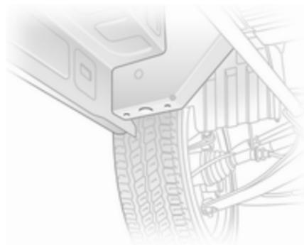
2. Allentare tutti i bulloni ruota di mezzo giro con il cricchetto e un adattatore. Per allentare i bulloni ruotare il cricchetto in senso antiorario. Capovolgere il cricchetto se necessario.
