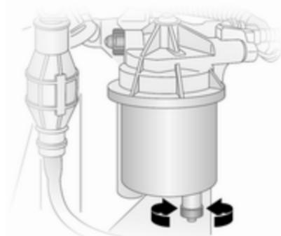
Eliminare l'acqua dal filtro diesel ad ogni sostituzione dell'olio motore.
