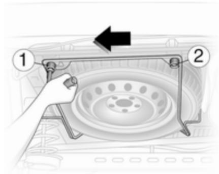
La ruota di scorta si trova sotto il sottoscocca posteriore ed è fissata con un bullone di sicurezza che può essere rimosso solo con l'attrezzo in dotazione.
