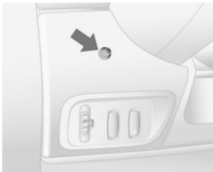
Oltre che con l'unità telecomando, il riscaldamento può essere acceso per 30 minuti o spento utilizzando il pulsante sul quadro strumenti.
