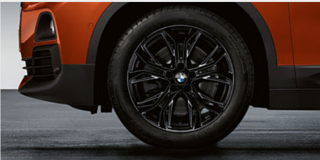
○ I pregiati cerchi in lega leggera da 18", styling a Y n° 566 sono neri e conferiscono alla vettura un aspetto particolarmente sportivo. Set di ruote estive completo RDC con pneumatici Runflat, dimensioni 7,5J x 18 con pneumatici 225/50 R18 95W RSC.
