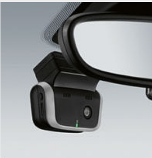
○ La telecamera Full HD altamente sensibile registra automaticamente la zona intorno alla vettura, in caso di scuotimenti di quest'ultima.
