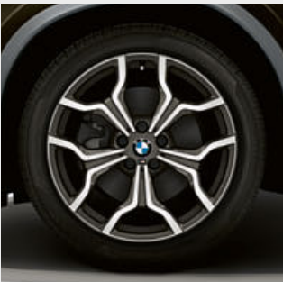
□ Cerchi in lega leggera M da 19", styling a Y n° 722 M, Orbit Grey con pneumatici Runflat, dimensioni 8J x 19 pneumatici 225/45 R19.
