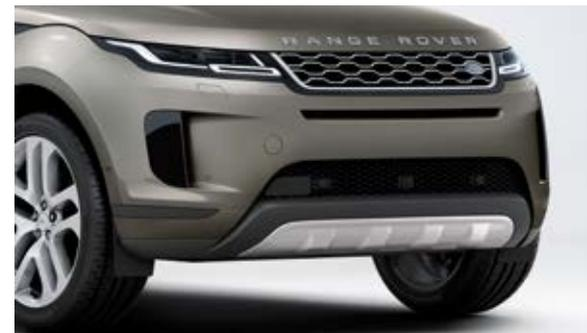
Piastra di protezione sottoscocca in acciaio inossidabile – Anteriore
