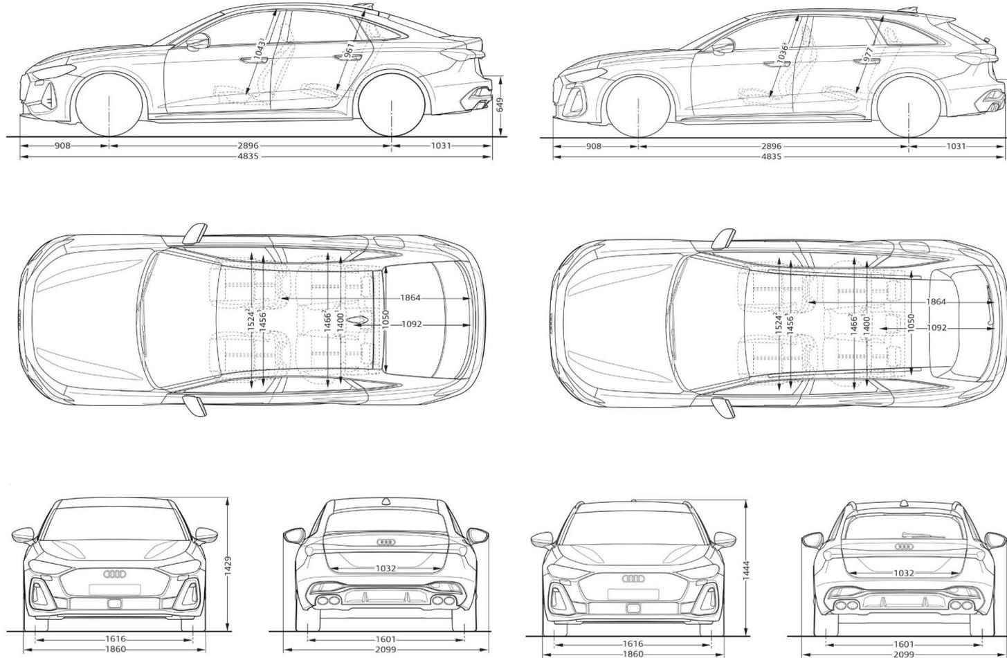
**Misure in millimetri** (indicazione delle dimensioni con massa a vuoto)
