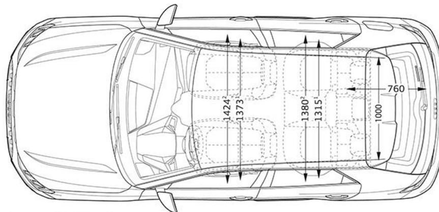
**Misure in millimetri.**
