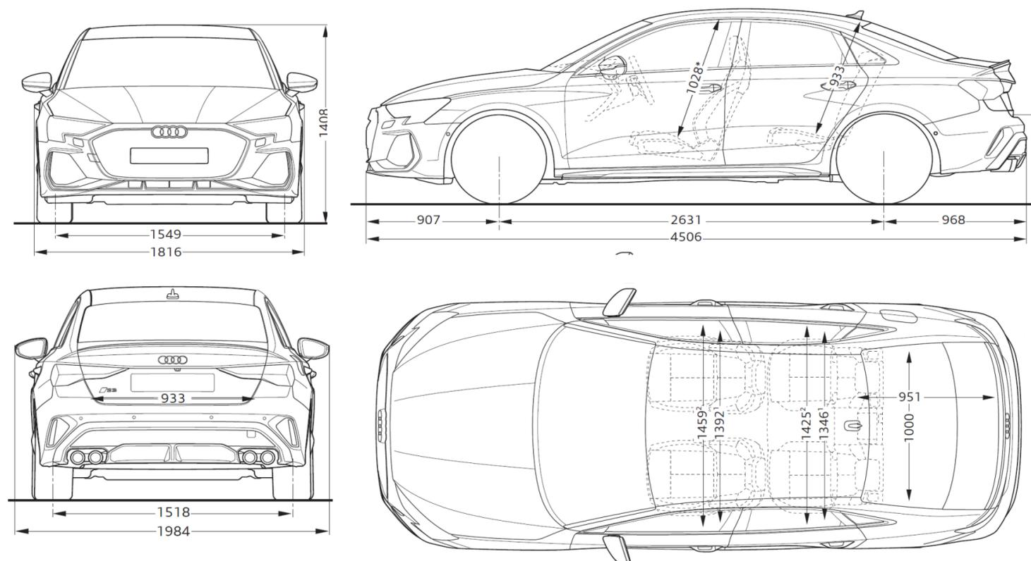
**NOTE:****Misure in millimetri** (indicazione delle dimensioni con massa a vuoto)
