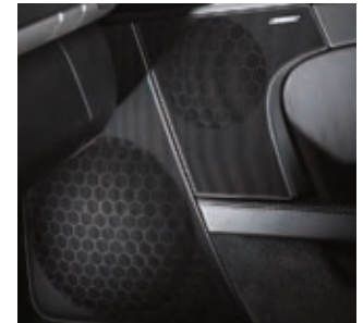
Altoparlante per toni medi da 8,0 cm Neodym e altoparlante per toni bassi 1) da 20,0 cm Nd®
