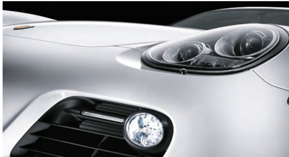
Fari Bi-Xenon con regolazione dinamica della luce in curva e luci diurne con tecnologia a LED
