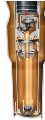
Estensione – pistone principale e bypass, impostazione morbida e confortevole
