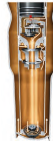
Compressione – pistone principale e bypass, impostazione morbida e confortevole
