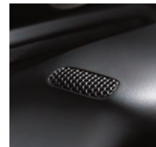
Microfono per AudioPilot® sul piantone dello sterzo
