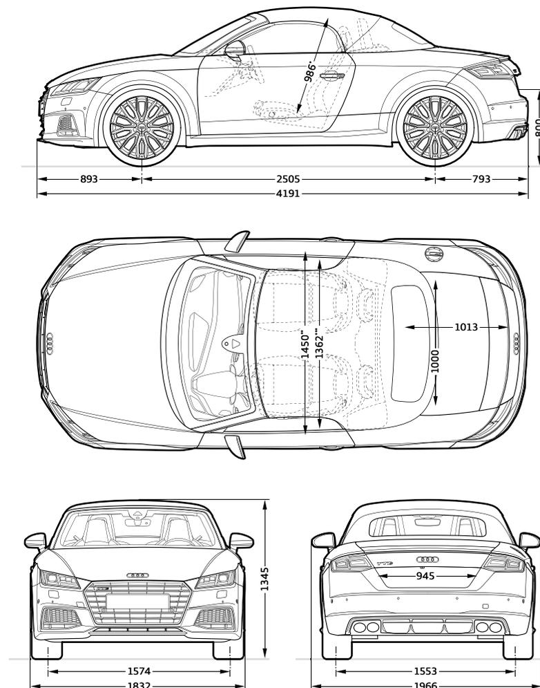
**Misure in millimetri.**
