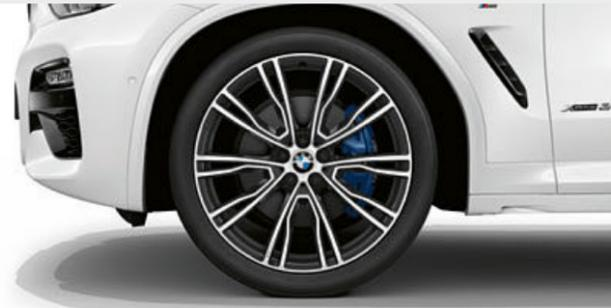
□ Cerchi in lega leggera BMW Individual da 21", styling a V n° 726 I Orbit Grey torniti a specchio con pneumatici misti Runflat, anteriori 8,5J x 21 con pneumatici 245/40 R21, posteriori 9,5J x 21 con pneumatici 275/35 R21.
