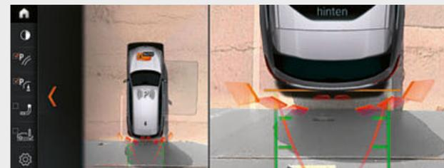
□ Il pacchetto di equipaggiamenti Parking Assistant Plus<sup>1,5</sup> facilita le manovre per il parcheggio della vettura. Comprende Surround View con Top View, Remote 3D View, PDC<sup>4</sup>, un assistente laterale per il parcheggio, la funzione di frenata d'emergenza Active PDC<sup>4</sup> e l'assistente di parcheggio con guida in direzione longitudinale, che parcheggia la vettura automaticamente in senso parallelo o trasversale alla corsia di marcia.
