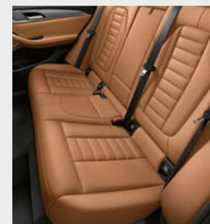
□ Per mezzo di una leva sul sedile posteriore sinistro e destro è possibile regolare gli schienali in avanti di cinque gradi e indietro di sei gradi.
