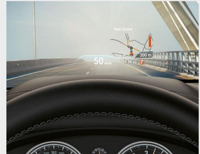
□ Il BMW Head-Up Display<sup>2</sup> a colori visualizza tutte le informazioni rilevanti per la guida direttamente nel campo visivo del conducente, permettendogli di concentrarsi completamente sul traffico. Vengono visualizzate informazioni come la velocità, le indicazioni del navigatore, le Speed Limit Info con indicazione del divieto di sorpasso, la rubrica telefonica e l'elenco dell'entertainment.
