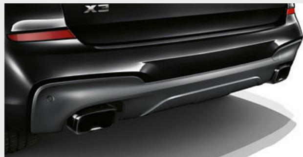
L'M Aerodynamic Package sottolinea esteticamente il carattere sportivo della vettura e modifica il flusso d'aria. Il pacchetto include una grembiatura anteriore con prese d'aria maggiorate, speciali minigonne laterali e una grembiatura posteriore con diffusore. I terminali di scarico doppi sono realizzati in Black cromato.
