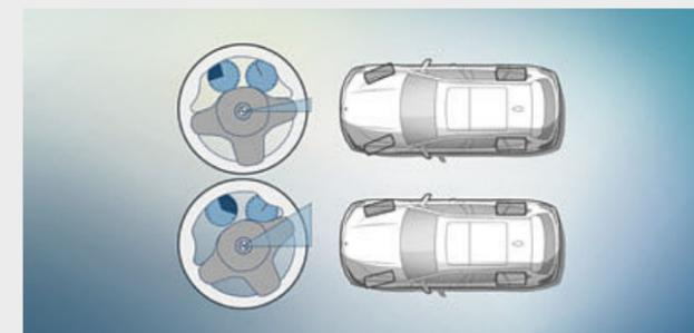
□ Grazie al **Variable Sport Steering**<sup>3</sup> con Servotronic si ottiene una risposta diretta e immediata dello sterzo e si riduce sensibilmente la forza da applicare sul volante per girare le ruote. Reagisce all'angolazione del volante con rapporti di sterzata variabili. Nelle guide più dinamiche l'handling è migliore e le manovre di parcheggio e di sterzo sono rese più facili.
