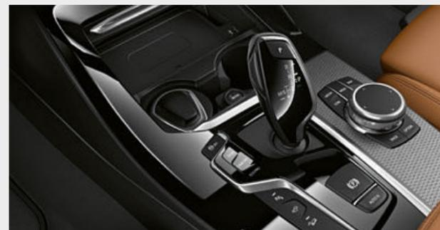
Il cambio Steptronic sportivo a 8 rapporti consente cambiate molto sportive, sia in automatico che manualmente con la leva selettoria o i paddle sul volante, per uno stile di guida orientato al comfort o molto dinamico. Nella modalità SPORT e con la leva selettoria a sinistra su S/M la gestione degli innesti è impostata in funzione della massima performance.
