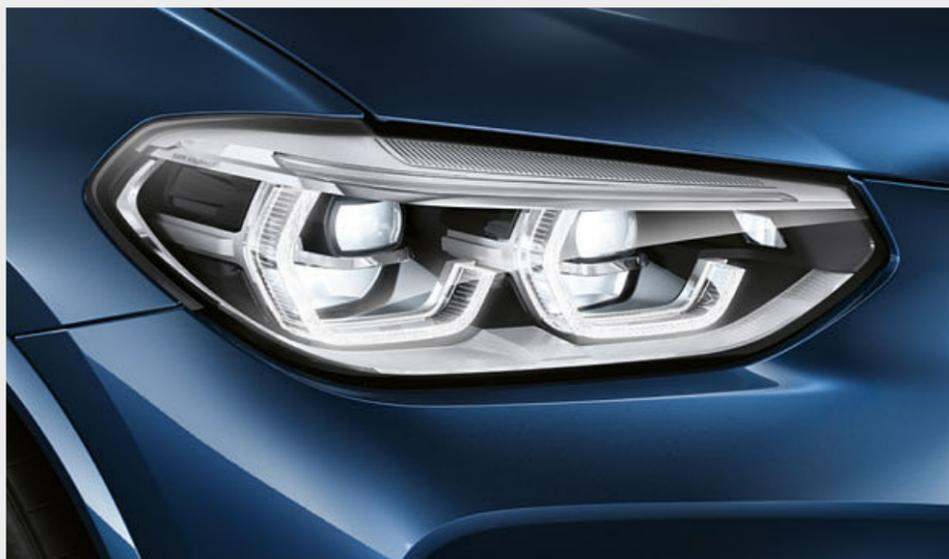
□ I fari LED adattivi anabbaglianti ed abbaglianti comprendono indicatori di direzione realizzati completamente con tecnologia LED. L'equipaggiamento comprende il BMW Selective Beam, le luci di svolta, le luci diurne e l'Adaptive Light Control (illuminazione adattativa in curva) con distribuzione variabile del fascio luminoso per illuminare in modo ottimale la strada e migliorare la visibilità nell'oscurità.
