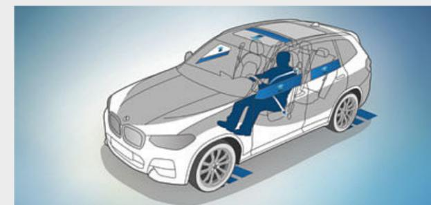
□ **Active Protection** rappresenta il sistema di protezione preventiva dei passeggeri di BMW ConnectedDrive. Active Protection avvisa il guidatore rilevando i segni di affaticamento. In situazioni critiche le cinture di sicurezza si tendono, i sedili a regolazione elettrica sono ripristinati in posizione verticale e i finestrini e il tettuccio scorrevole sono chiusi. Dopo un incidente, i freni sono azionati automaticamente per arrestare la vettura.
