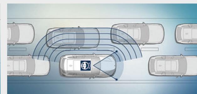
□ L'**Assistente di sterzata e di controllo corsia**<sup>4</sup> con assistente di guida in colonna fornisce supporto al guidatore in situazioni di guida monotona. Tra 0 e 210 km/h il sistema manovra la vettura, con il massimo comfort, su tutti i tipi di strada mantenendola sempre al centro della corsia. L'Assistente di guida e tenuta corsia è disponibile indipendentemente dall'Active Cruise Control.
