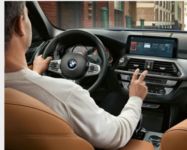
□ Con il BMW Gesture Control<sup>1</sup> è possibile attivare determinate funzioni con alcuni movimenti della mano. Per determinati comandi il sistema riconosce gesti prestabiliti, ad esempio il gesto di cancellare o indicare, con cui si può rifiutare o accettare una chiamata in arrivo, o i movimenti rotatori del dito indice, con cui si può regolare il volume.
