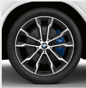
□ Cerchi in lega leggera M da 20", styling a doppi raggi n° 699 M Orbit Grey bicolore torniti<sup>3</sup> a specchio con pneumatici misti Runflat anteriori 8J x 20 con pneumatici 245/45 R20, posteriori 9,5J x 20 con pneumatici 275/40 R20.
