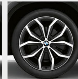
□ Cerchi in lega leggera da 20", styling a Y n° 695 Orbit Grey bicolore torniti a specchio con pneumatici misti Runflat, anteriori 8J x 20 con pneumatici 245/45 R20, posteriori 9,5J x 20 con pneumatici 275/40 R20.
