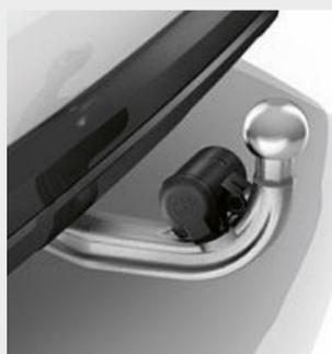
□ Il gancio di traino con sfera regolabile elettronicamente e controllo di stabilità del rimorchio è in grado di trainare carichi pesanti fino a 2,000 kg.
