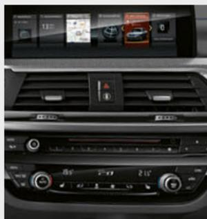
■ Il climatizzatore automatico tri-zona include il controllo automatico del ricircolo dell'aria (AUC) con microfiltro a carboni attivi, oltre a un sensore solare e antiappannamento.
