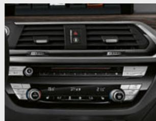
□ Il climatizzatore automatico tri-zona include il controllo automatico del ricircolo dell'aria (AUC) con microfiltro a carboni attivi, oltre a un sensore solare e antiappannamento.
