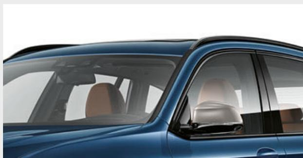
□ I vetri ad alto isolamento acustico anteriori completano l'isolamento del parabrezza e riducono la rumorosità nell'abitacolo durante la marcia. Il flusso dell'aria, i disturbi ambientali nonché il rumore del motore, degli pneumatici e dei tergicristalli sono attenuati. Il risultato è particolarmente apprezzato dagli amanti della musica o da chi utilizza il dispositivo vivavoce.
