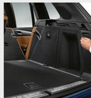
□ Lo sblocco a distanza dello schienale posteriore permette allo schienale di essere sbloccato e ripiegato comodamente con un pulsante nel vano bagagli.
