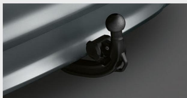
□ Il gancio di traino con sfera regolabile elettronicamente è in grado di trainare carichi pesanti fino a 2.000 kg. Per la stabilizzazione, il controllo di stabilità del rimorchio frena automaticamente se riconosce un movimento oscillatorio del rimorchio. La sfera regolabile elettronicamente non è visibile quando è ripiegata sotto la grembiatura posteriore.
