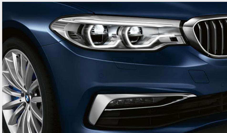
□ I fari LED adattivi comprendono BMW Selective Beam, luci di svolta e Light Control. Il fascio di luce particolarmente luminoso è simile alla luce naturale diurna e crea un'illuminazione ottimale della strada migliorando la visibilità e rendendo la guida meno stancante. Di notte la vettura si riconosce subito come una BMW grazie al design iconico delle luci con quattro anelli luminosi.
