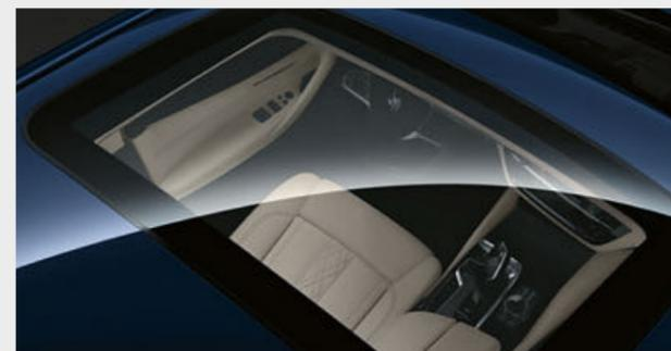
□ Il tettuccio panoramico in vetro, scorrevole ed inclinabile, con cielo del padiglione ad azionamento elettrico, protezione antincastro e apertura/chiusura comfort assicura una circolazione regolabile dell'aria e quindi un clima piacevole nell'abitacolo. Il frangivento integrato protegge dalle correnti d'aria nell'abitacolo e riduce la rumorosità.
