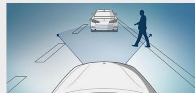
■ La **segnalazione di persone con funzione di frenata City**<sup>2</sup> supporta attivamente il conducente al fine di evitare collisioni con i pedoni. Funziona a velocità fino a 60 km/h e predisporre i freni per intervenire con maggior prontezza. In caso di emergenza, il sistema si attiva per evitare collisioni e a tal fine riduce sensibilmente la velocità.
