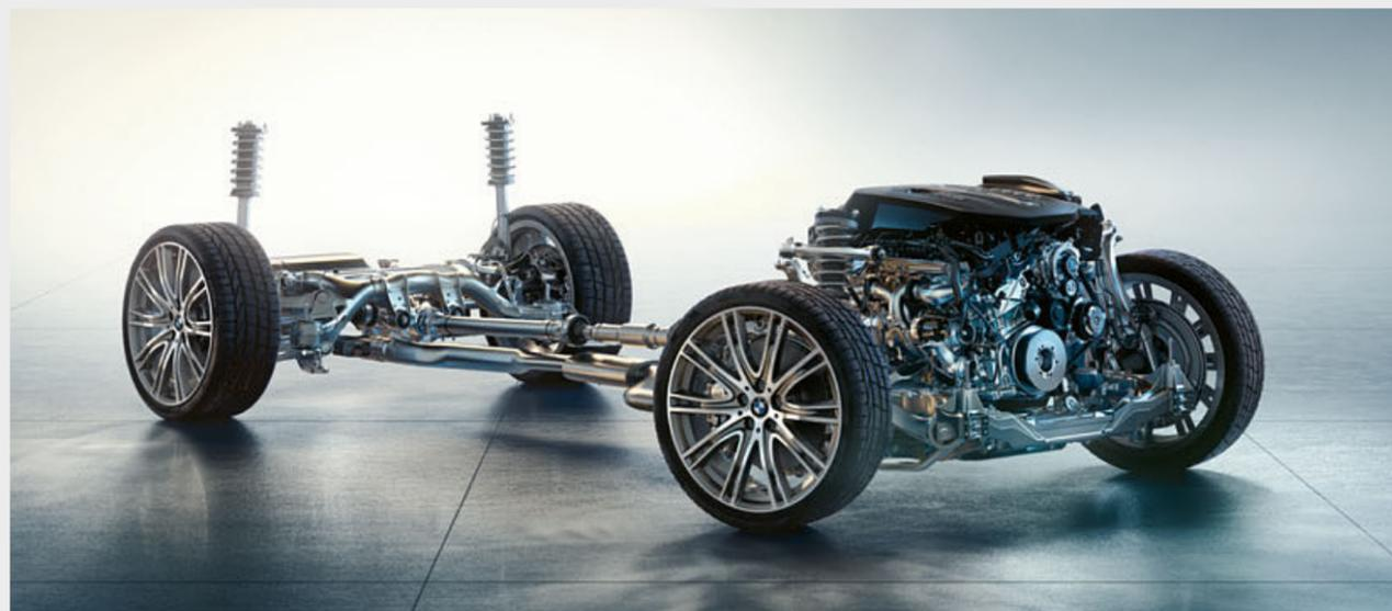
L'**Integral Active Steering**<sup>1</sup> combina una demoltiplicazione che dipende dall'angolo di sterzata sull'asse anteriore e un asse posteriore sterzante. Alle basse velocità le ruote posteriori sterzano in direzione opposta rispetto a quella delle ruote anteriori, per cui migliorano la manovrabilità e l'agilità. Da circa 60 km/h le ruote posteriori sterzano nella stessa direzione delle ruote anteriori, aumentando la stabilità di marcia e il comfort.<sup>4</sup>
