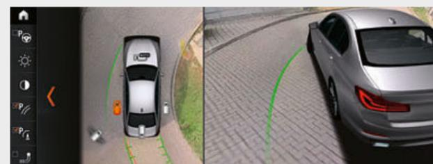
□ Il pacchetto di equipaggiamenti Parking Assistant Plus<sup>6</sup> facilita le manovre per il parcheggio della vettura. Comprende Surround View con Top View, Remote 3D View, PDC e l'assistente di parcheggio con guida in direzione longitudinale, che parcheggia la vettura automaticamente in senso parallelo o trasversale alla corsia di marcia. A tale scopo, il sistema misura le dimensioni dei posti di parcheggio, se si viaggia a bassa velocità.
