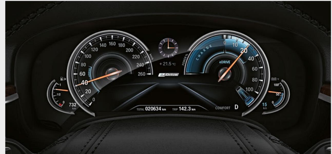
La strumentazione specifica iPerformance indica ad esempio quando la vettura è pronta a operare con propulsione elettrica, il livello attuale di carica della batteria e il consumo di energia elettrica.
