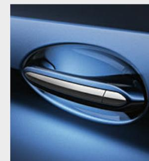
□ Con il Soft Close Automatic, le portiere si chiudono automaticamente e praticamente senza rumore, una volta avvicinate alla serratura.
