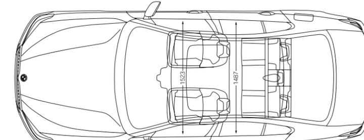
Tutte le misure dei disegni tecnici sono espresse in millimetri. L'altezza senza antenna è di 1466 mm. I dati relativi a prestazioni, consumi ed emissioni di CO<sub>2</sub> si riferiscono alle vetture con cambio di serie. I valori tra [ ] si riferiscono ai modelli con cambio Steptronic.
