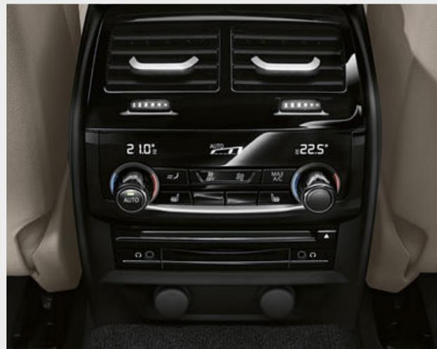
□ Oltre che delle funzioni del climatizzatore bi-zona con funzioni estese, il climatizzatore automatico quadizona è dotato di due bocchette d'aria supplementari nei montanti centrali. Inoltre la temperatura del retro dell'abitacolo è regolabile con un comando separato dotato di display.
