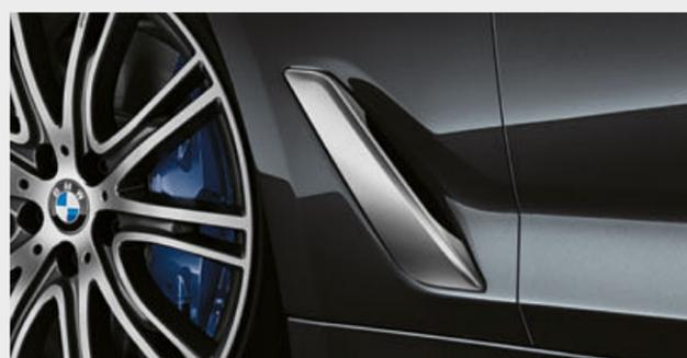
■ L'Air Breather canalizza il flusso dell'aria sulle ruote anteriori riducendo la resistenza aerodinamica, il consumo di carburante e le emissioni di CO<sub>2</sub>.
