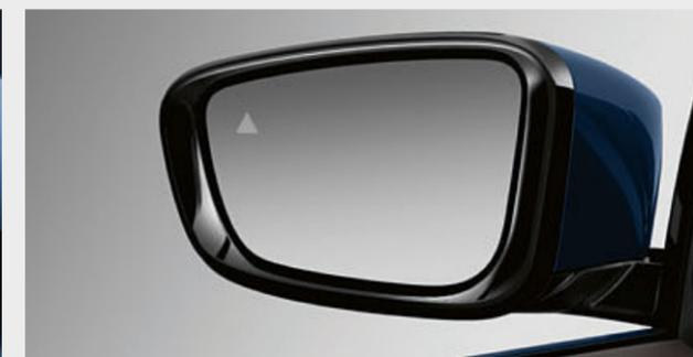
□ Con gli indicatori di direzione<sup>2</sup> accesi, il Segnalatore di sorpasso pericoloso basato su sensori radar, attira l'attenzione del conducente nel caso in cui rilevi la presenza di veicoli nella corsia vicina o nell'angolo cieco. Il sistema funziona a velocità di 20 km/h o superiori e, in situazioni di pericolo, avverte il guidatore con una vibrazione del volante e con un simbolo di allerta a forma di triangolo sui retrovisori esterni.
