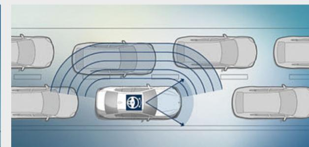
□ L'**Avvisatore di cambio accidentale**<sup>3</sup> della corsia di marcia rileva le delimitazioni della corsia e avvisa il conducente se sta cambiando inavvertitamente corsia di marcia, a velocità superiori a circa 70 km/h, con leggere vibrazioni del volante. L'avvisatore non entra in funzione quando il cambio di corsia non è accidentale, cioè se sono stati attivati gli indicatori di direzione.
