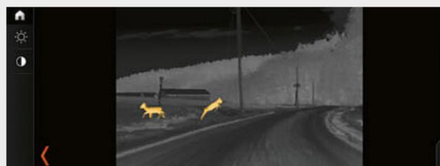
□ Il BMW Night Vision con sistema di riconoscimento automatico delle persone rende possibile l'identificazione delle persone e degli animali di grandi dimensioni a grande distanza di notte grazie a un'immagine termica sul Control Display e le illumina in modo mirato con il Dynamic Marker Light dei gruppi ottici principali. Un sistema di allerta aggiuntivo si attiva automaticamente accendendo il veicolo, indipendentemente dalle immagini visualizzate sul display.
