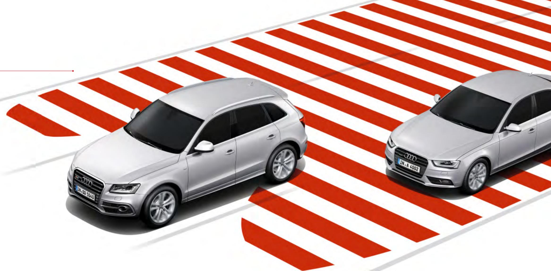
**Audi side assist\***: dispositivo di assistenza per cambio di corsia: entro limiti prestabiliti, a partire da una velocità di 30 km/h controlla mediante tecnica radar la zona dietro e accanto alla vettura e informa il conducente tramite un LED nello specchio retrovisivo esterno se ha individuato una situazione critica, ossia la presenza di un veicolo sulla corsia vicina e quindi l'impossibilità di un cambio di corsia.
