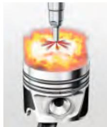
**La preiniezione** consente una combustione «morbida» e quindi una minore rumorosità e un funzionamento più dolce del motore.
