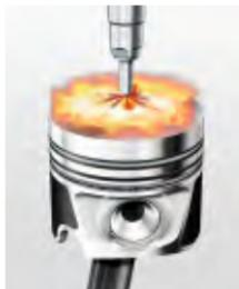
**Gli iniettori piezoelettrici** si aprono e si chiudono in pochi millesimi di secondo, iniettando più volte il carburante nella camera di combustione ad una pressione fino a 2.000 bar. A ogni fase vengono iniettate minuscole quantità di carburante, inferiori a un millesimo di grammo.
