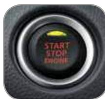
Il KOS\* consente l'apertura e la chiusura delle portiere, nonché l'avviamento (e spegnimento) del motore tramite l'apposito tasto.
