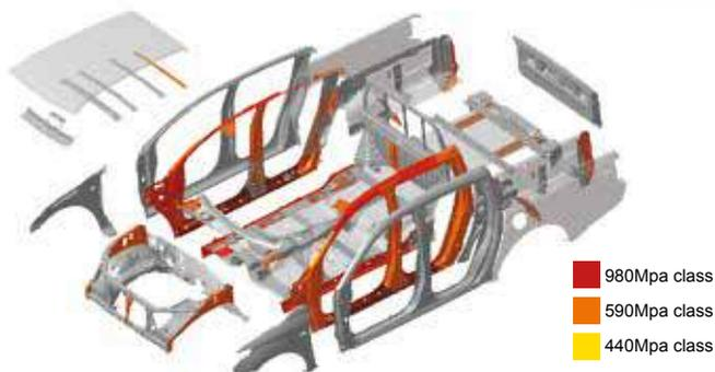
Per ridurre il peso del telaio mantenendo un elevato livello di sicurezza la scocca è stata realizzata con numerosi componenti in acciaio speciale, leggero e con alta resistenza alla trazione.
