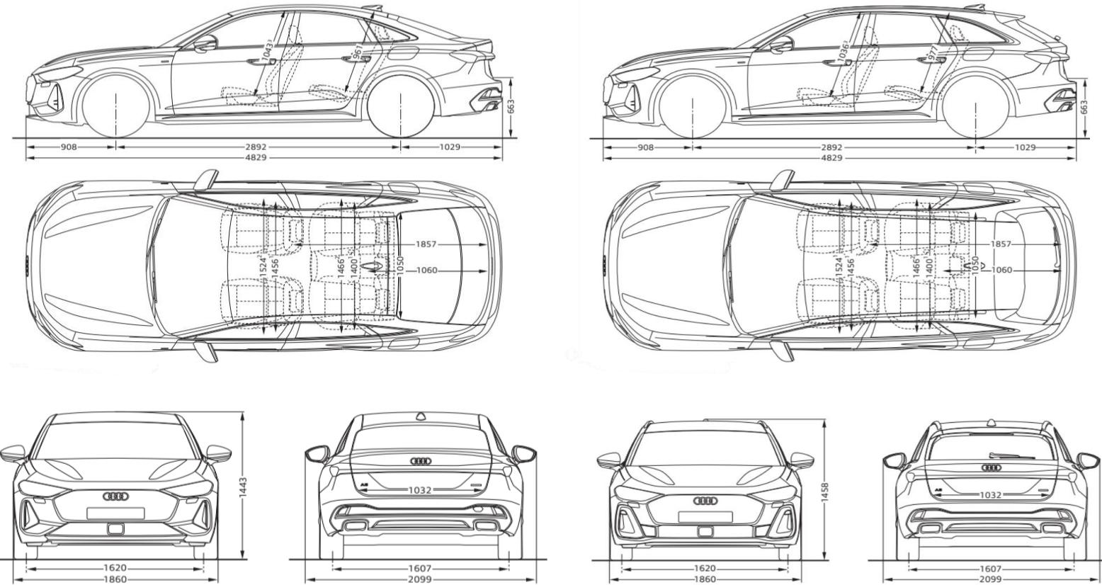
**Misure in millimetri** (indicazione delle dimensioni con massa a vuoto)
