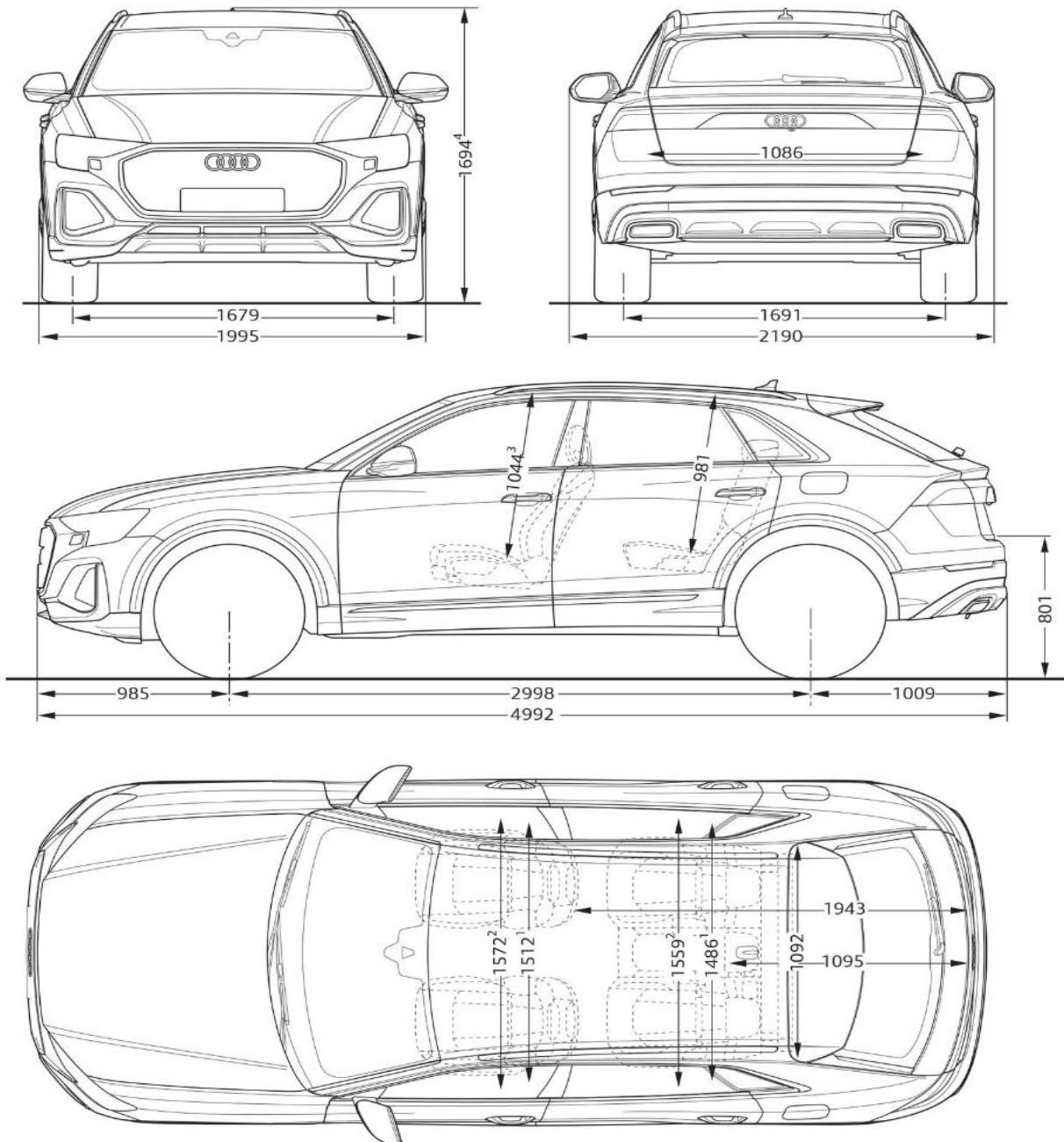
**Misure in millimetri** (indicazione delle dimensioni con massa a vuoto)<sup>1</sup> = Larghezza al livello delle spalle   <sup>2</sup> = Larghezza al livello dei gomiti   <sup>3</sup> = Spazio massimo per la testa   <sup>4</sup> = Altezza della vettura inclusa l'antenna sul tetto
