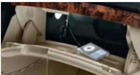
L'**MDI** (Mobile Device Interface) consente di comandare dispositivi esterni mediante la radio o il sistema di navigazione e di riprodurre file MP3, WMA, OGG e AAC oppure playlist memorizzate sul dispositivo stesso. I cavi di connessione per iPod, prese Aux-in o USB sono compresi nella gamma di Accessori Originali ŠKODA.
