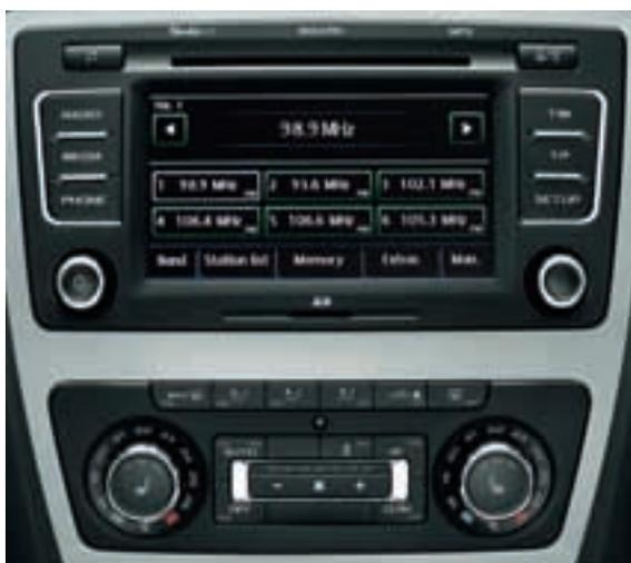
La **radio Bolero**, con caricatore 6 CD integrato e lettore di schede di memoria SD e MMC, permette di riprodurre CD musicali e file in formato MP3 e WMA.
