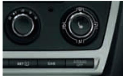
Il veicolo è dotato sia di **interruttore automatico** che **manuale** per scegliere tra le due versioni di carburante. L'interruttore manuale è eseguito dal pulsante GAS e può essere utilizzato mentre il motore è acceso, anche quando la vettura è in movimento.
