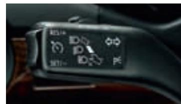
Il **regolatore di velocità** è in grado di mantenere la velocità impostata, ad esempio in autostrada. Quando il regolatore di velocità è attivo, la relativa spia sul quadro strumenti rimane accesa.
