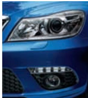
I **fari allo xeno con moduli orientabili** vantano una luminosità particolarmente intensa garantendo così sempre massima visibilità in curva. Le luci diurne si presentano come diodi LED, posti al di sopra dei fari fendinebbia nel design tipico della versione RS.
