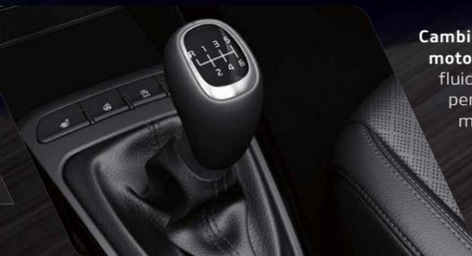
**Cambio manuale a 5 e 6 marce (sui motori diesel)** per cambiate rapide e fluide e rapporti al cambio selezionati per adattarsi alla curva di coppia del motore.
