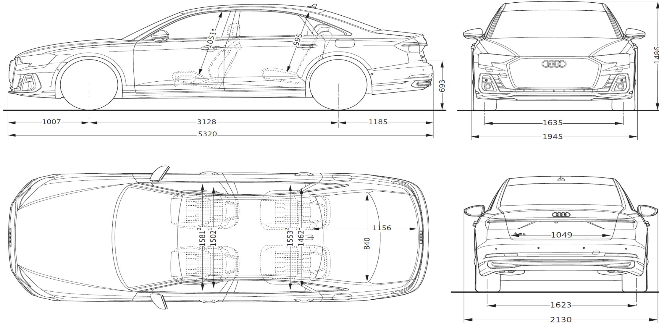
**Misure in millimetri.**
